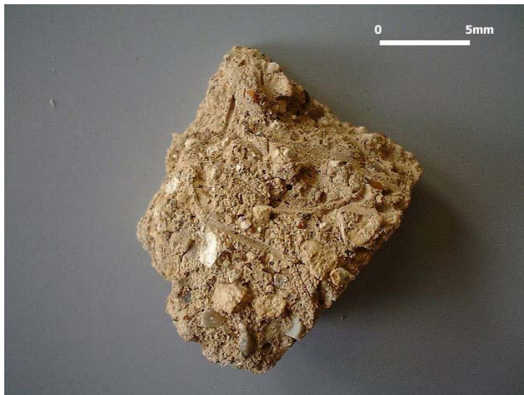
Fig.I.13. Paille dans un mortier de préparation d'enduit peint du sanctuaire de Ribemont-sur-Ancre (Somme), échantillon RSAEP 10, couche (c).
