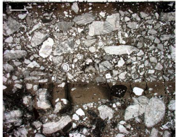
Fig.I.19. Vides polyconcaves (en blanc). Un grumeau a partiellement disparu au centre. Enduit peint de Roz Avel, échantillon ROZ 13, LPNA.
