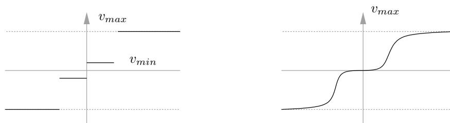
FIG. 6.19 – Deux exemples de fonction f_{vitesse} . À gauche, la fonction permet deux vitesses : lente pour les faibles variations et rapide pour les grandes variations. À droite, c’est le même principe en plus continu.
