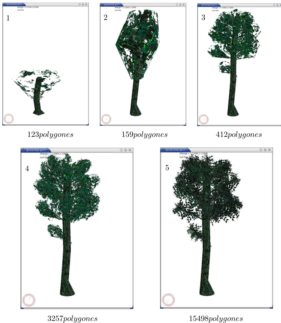
FIG. 7.22 – La précision de cet arbre varie, à titre illustratif, de façon uniforme et indépendamment du point de vue. On remarque ainsi les différents niveaux de détail : trois niveaux d’enveloppes imbriquées laissent ensuite place aux feuilles. Lorsque l’arbre est très loin, il s’enterre dans le sol : c’est le terrain qui doit alors être texturé de façon à représenter une forêt.
