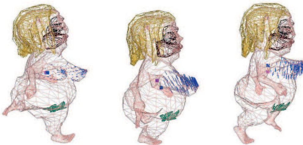
FIG. 4.19 – Animation de la poitrine d'un personnage : visualisation des déformations en affichage fil de fer ainsi que du mouvement du ressort amorti.
