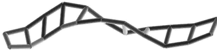
FIG. 5.28 - Le réseau après application des forces.
