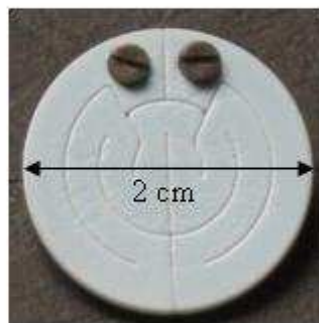
Figure 3-14 : Photographie de l'élément chauffant miniaturisé
