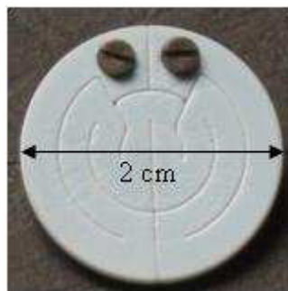
Figure 3-14 : Photographie de l'élément chauffant miniaturisé
