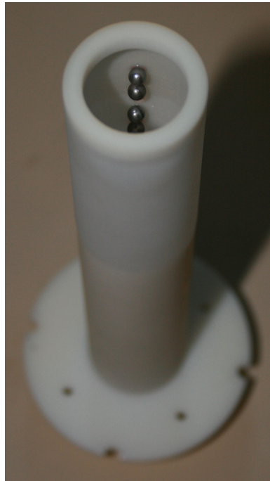
FIGURE 4.8 – Fantôme équipé de 4 billes pour la calibration géométrique du micro-TDM
