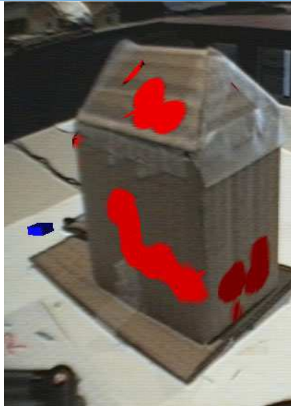
Fig. 8.9: Peinture en mode simple : la peinture virtuelle est juste déposée sur l'élément réel.
