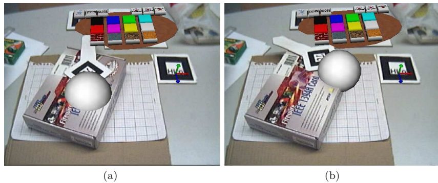
Fig. 5.25: Résultat pour l'esquisse sur modèle polygonal avec la gestion des occultations. Un modèle fantôme est associé à la boîte sur les figures (a) et (b) et une intersection est faite avec une sphère virtuelle.
