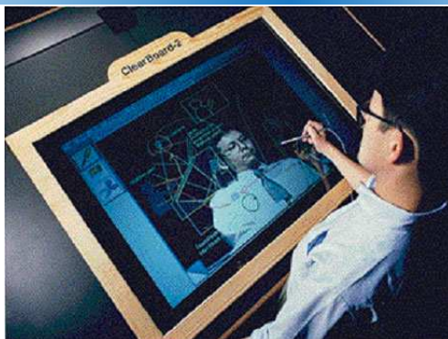
Fig. 2.12: Exemple de collecticiel distant synchrone : Clearboard [IKJG92]. Deux utilisateurs peuvent esquisser un modèle virtuel.
