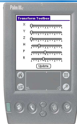
Fig. 7.18: Interaction à partir d'un autre référentiel : interaction par PDA pour le contrôle de l'orientation du contenu d'un tangible AR document à l'aide de sliders.
