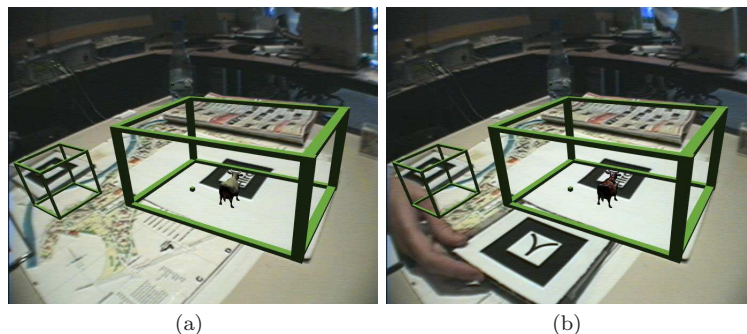
Fig. 7.16: changement de représentation par couplage de l'outil. Le modèle virtuel de vache passe ici d'un mode face caché basique à un mode de rendu haute qualité. L'effet n'est pas persistant, la déconnexion physique supprimant la relation.
