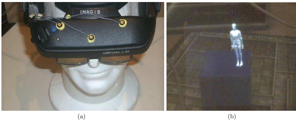
Fig. A.6: Le prototype de casque optique (a) et une vue de l'image perceptible à travers (b).
