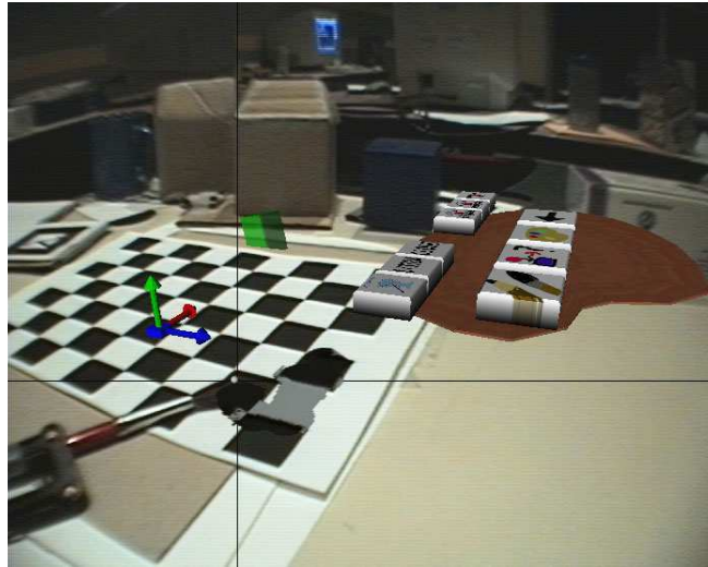
Fig. 8.12: Peinture avec acquisition de la texture à la volée : nous montrons la validité du système en re-appliquant la valeur saisie directement sur l'objet (mode de peinture copie). Nous pouvons noter que la grille réel-virtuel semble se coordonner de façon assez naturelle, avec toutefois quelques petites imprécisions..
