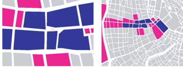
FIG. 1.34 – Un exemple de précalcul : en bleu les bâtiments visibles du centre de la cellule, en rose les bâtiments potentiellement visibles de la cellule.
