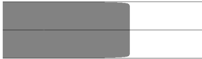
Figure 8-5: Forme du front de matière calculée à l'aide du code FLUENT (viscosité constante)
