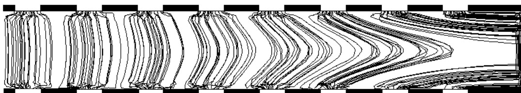
Figure 2-16: Trajectoire du fluide dans l'échantillon en présence d'un effet de bord.
