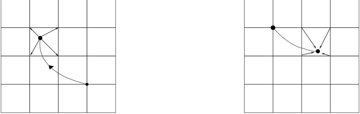
FIGURE 4.1 – Principe de FSL (gauche) et BSL (droite) pour des splines linéaires.
