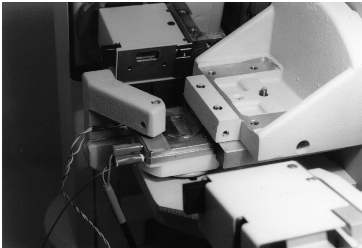
Figure I-19: cellule électrochimique montée sur le diffractomètre Siemens D5000
