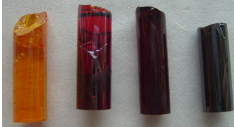
Figure IV.1 : Photo de différents échantillons du système GeS_2-Sb_2S_3-CsI . De gauche à droite : 90(GeS_2)-10(Sb_2S_3) , 66,25(GeS_2)-26,25(Sb_2S_3)-7,5CsI , 75(GeS_2)-10(Sb_2S_3)-15CsI et 42,5(GeS_2)-42,5(Sb_2S_3)-15CsI .
