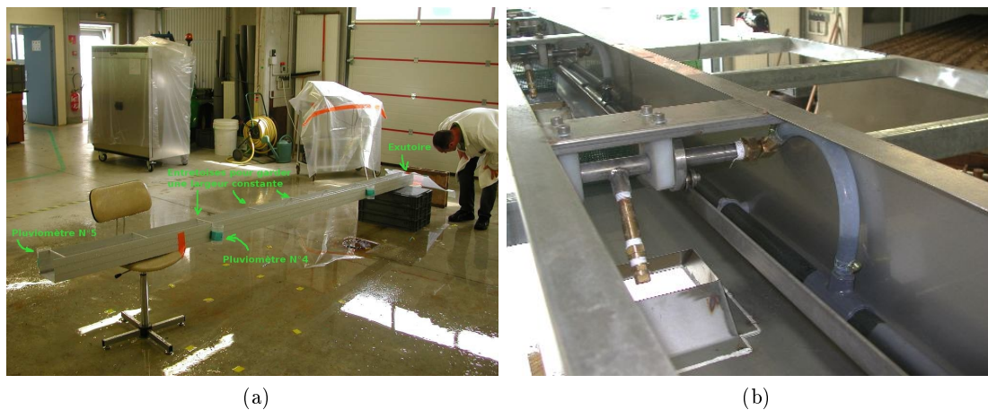
FIGURE 6.1 – Dispositif expérimental. (a) Le canal et (b) Les gicleurs (photos de l’unité Science du sol de l’INRA d’Orléans).
