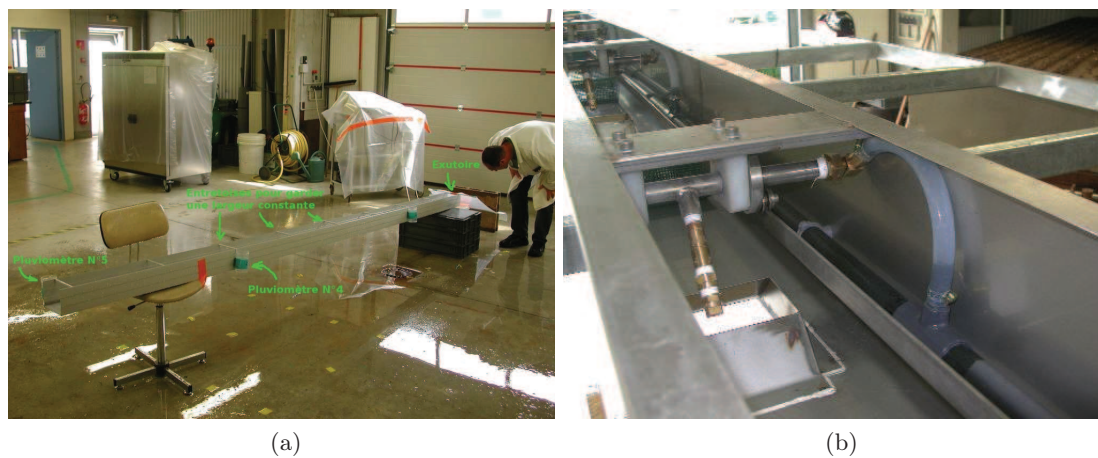
FIG. 6.1: Dispositif expérimental. (a) Le canal et (b) Les gicleurs (photos de l'unité Science du sol de l'INRA d'Orléans).
