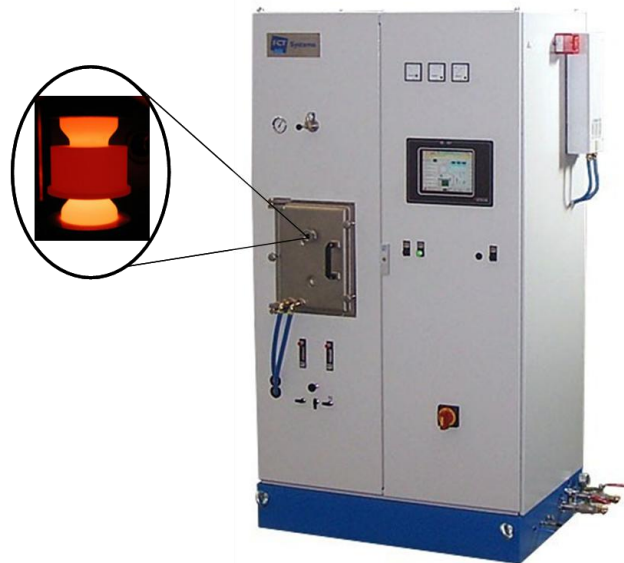
Figure 4.7. Image représentant l'installation de frittage flash HP D5 [11]
