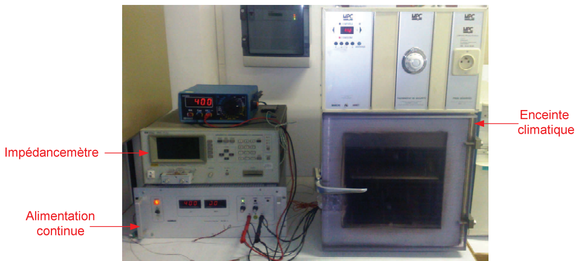
Fig.2. 7 : Banc du vieillissement standard
