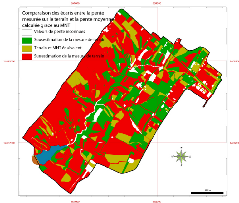
Figure 4.3 : Comparaison entre les valeurs de pente mesurées et les valeurs de pente moyennes calculées à partir du MNT.
