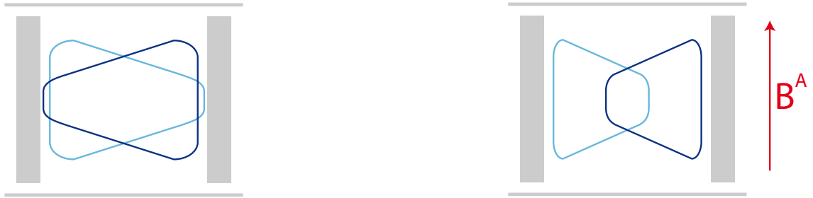
FIG. 5.19 – Les cellules bleus représentent l'écoulement que créerait la rotation d'un disque dans le cas où la cuve serait un cylindre infini avec un disque à chaque extrémité. A gauche, le champ est nul, la taille de la cellule est fixée par la dissipation turbulente. A droite, un champ transverse est appliqué, la taille de la structure est alors fixée par la dissipation turbulente et l'effet Joule.
