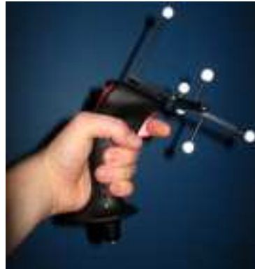
FIG. B.6 – Un flystick muni de capteurs optiques de localisation
