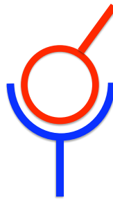
FIG. 3.9 – Représentation schématique d'une liaison rotule
