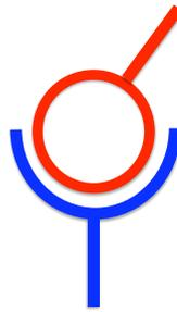
FIG. 3.9 – Représentation schématique d'une liaison rotule
