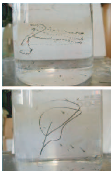
FIG. 3.7 – Comparaison de deux fibres composites PVA/Nanotubes élaborées avec une poudre évaporée (en haut) et lyophilisée (en bas)(CRPP).
