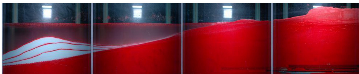
FIG. V.2 – Modélisation d'un rechargement sédimentaire d'avant côte dans le canal à houle du LEGI, Université Joseph Fourier à Grenoble (Grasso, 2009). Le sédiment est constitué d'une poudre plastique de faible masse volumique ( \rho_s = 1,19 \text{ g.cm}^{-3} ) et de diamètre médian de 0,6 mm. La portion de plage représentée sur la photographie est longue de 8 m.
