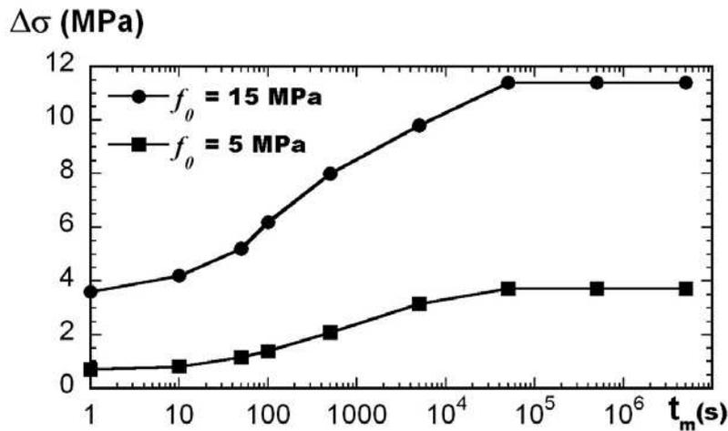
figure II-8. Variation simulée du pic de vieillissement  $\Delta\sigma$  en fonction du temps de maintien  $t_m$  pour deux valeurs de la contrainte maximale d'épinglage  $f_0$  (5 et 15 MPa) pour un temps de relaxation de 10 s.
