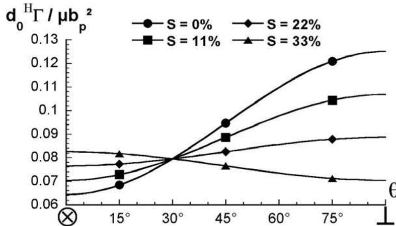
figure III-24. Effet de l'indice d'écrantage sur la largeur de dissociation normalisée par  $\mu b_p^2/\Gamma$ , avec  $b_p$  norme du vecteur de Burgers des partielles et  $\Gamma$  l'énergie de faute d'empilement, en fonction du caractère de la dislocation parfaite.
