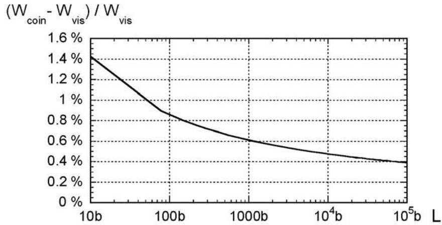
figure III-16. Ecart entre une configuration « vis » (représentée figure III-15) et une configuration « coin » de la boucle hexagonale en fonction de la longueur d'un segment pour  $S(T,c) = 0\%$ .
