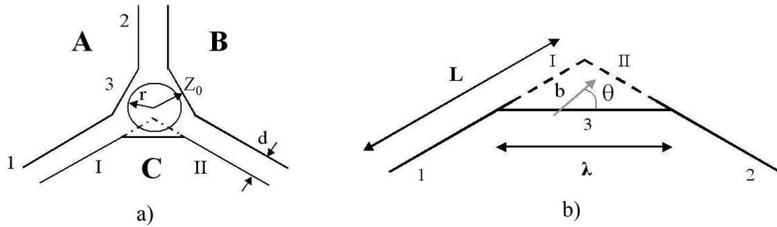
figure III-31 Représentation schématique d'un nœud triple de caractère  $\theta$  en segments rigides d'après Jøssang et al. [32]. a) Représentation d'un nœud triple en segments rectilignes. b) Décomposition d'une dislocation isolée du nœud triple. Les segments pointillés définissent le nœud dans son état « contracté ».
