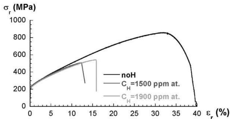
figure IV-19. Courbes contrainte vraie-déformation vraie de l'alliage binaire Ni-16Cr non chargé et chargé en hydrogène aux niveaux « bas » et « haut » ( $C_H = 1500$  et  $1900$  ppm atomique) pour une vitesse de déformation de  $10^{-2} s^{-1}$  à la température ambiante.
