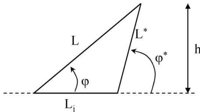
figure III-20. Evolution géométrique d'un bras ( $L$ ,  $\varphi$ ) ancré à une distance  $h$  de l'axe de la jonction lors de la formation d'une jonction.  $L^*$ ,  $\varphi^*$  sont respectivement la longueur et l'angle du bras à l'équilibre et  $L_j$  caractérise la demi-longueur de la jonction formée.
