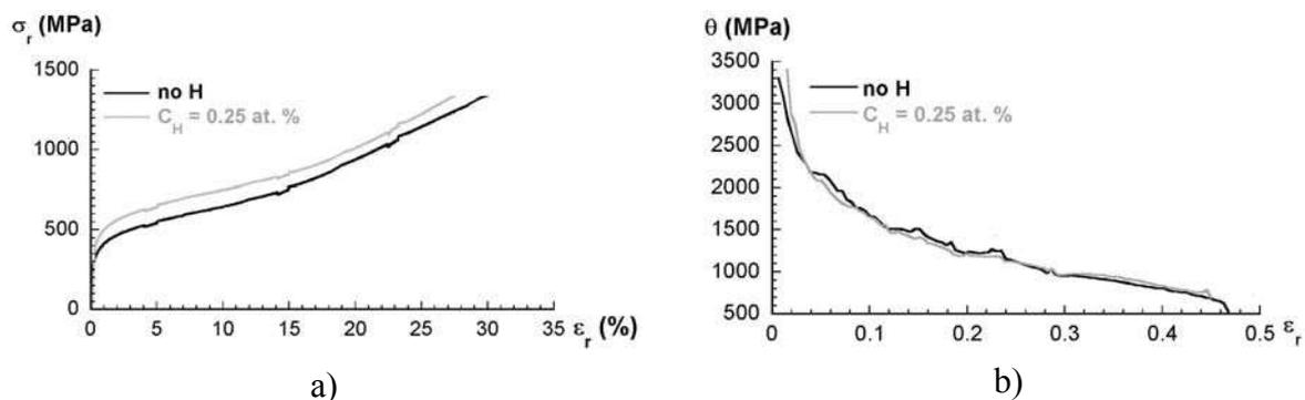
figure IV-22. Influence de l'hydrogène ( $C_H = 0,25\%$  atomique) sur le comportement en traction d'un acier austénitique AISI 316L à la température ambiante pour une vitesse de déformation de  $10^{-3} \text{ s}^{-1}$ .
