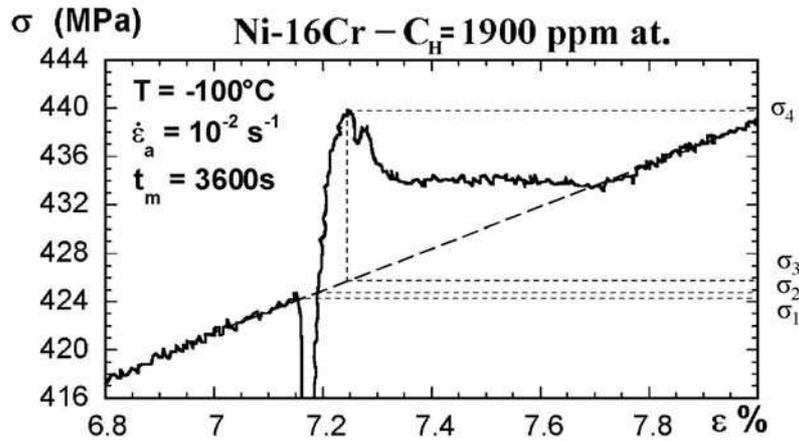
figure II-13. Mesure expérimentale du pic de vieillissement sur une éprouvette d'alliage Ni-16Cr contenant 1900 ppm atomique d'hydrogène à  $-100^{\circ}\text{C}$ , pour une vitesse de déformation de  $10^{-2} \text{ s}^{-1}$  et un temps de maintien de 3600 s. Nous utiliserons la convention de mesure proposée par Combette et Grilhé [13], à savoir  $\Delta\sigma = \sigma_4 - \sigma_3$ . Ici, le résultat est 15,4 MPa.
