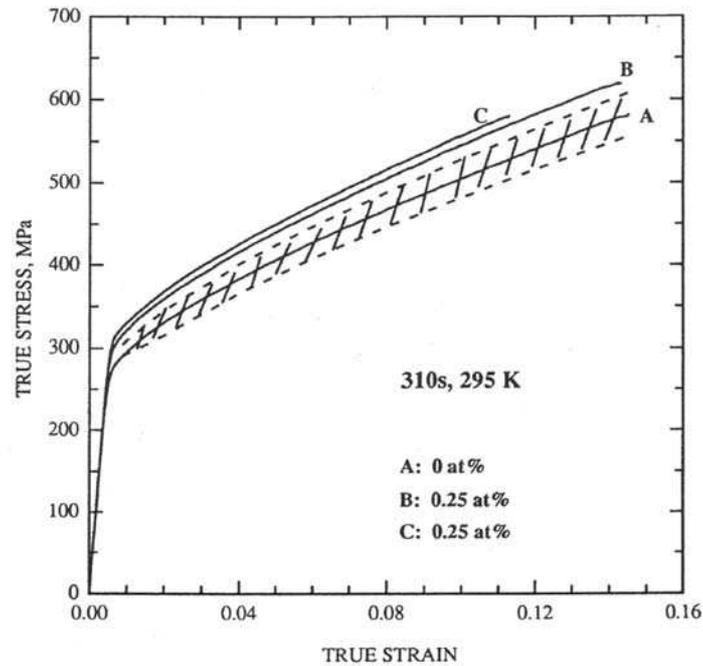
figure IV-23. Courbes contrainte vraie-déformation vraie à la température ambiante pour une vitesse de déformation de  $5,5 \times 10^{-5} \text{ s}^{-1}$  de l'acier austénitique AISI 310s non hydrogéné et pour une teneur en hydrogène de 0,25% atomique. D'après Abraham et Alstetter [3].
