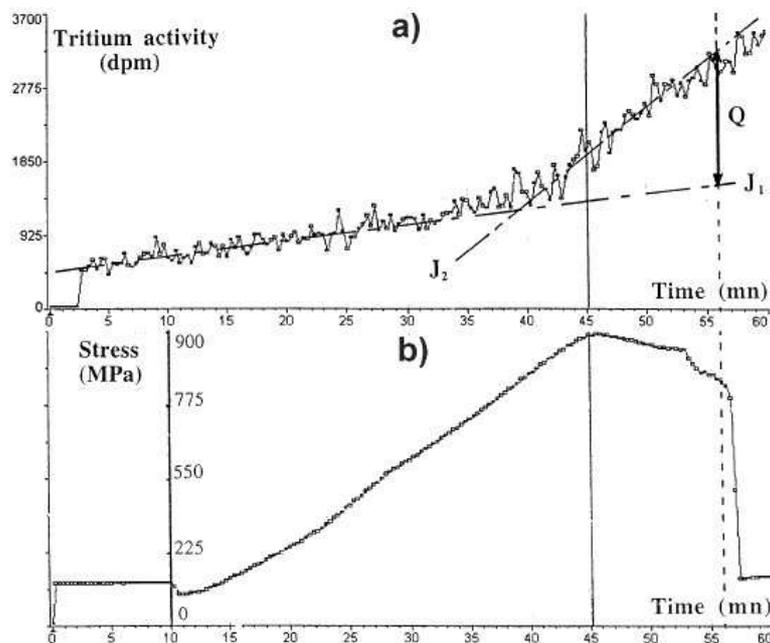
figure I-6. Mesure de la quantité de tritium désorbé à 293K lors d’un essai de traction ( $\dot{\epsilon} = 1,5 \times 10^{-4} \text{ mm.s}^{-1}$ ) interrompu pour  $\epsilon = 2,3\%$  sur monocristal de superalliage à base de nickel orienté  $\langle 100 \rangle$ . a) Quantité de tritium désorbé, mesurée en dpm (désintégrations par minute), en fonction du temps. b) Courbe de traction du monocristal donnée en fonction du temps. D’après Chêne et Brass [37].
