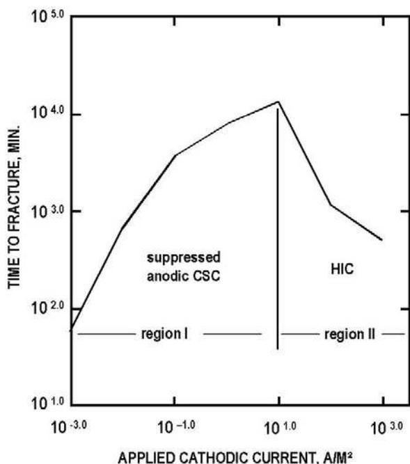
figure I-1. Influence du courant cathodique sur le temps à rupture à charge constante d’un acier austénitique de type 321 dans une solution de LiCl à 143°C. D’après Quiao et al. [14]
