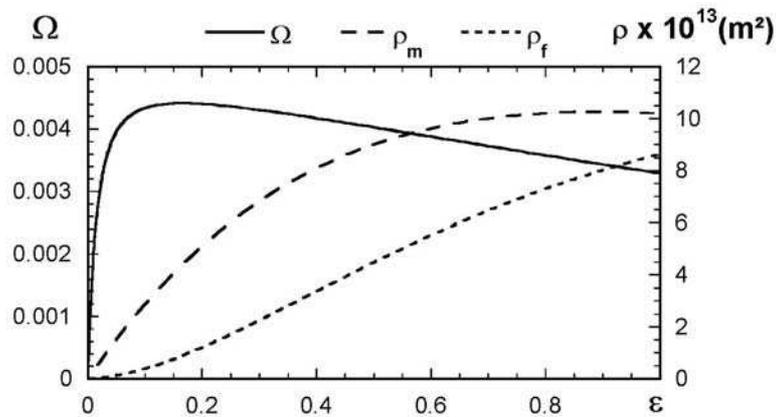
figure II-4. Evolution des densités de dislocations mobiles  $\rho_m$  et de la forêt  $\rho_f$  ainsi que de  $\Omega(\varepsilon)$  (déformation élémentaire obtenue lorsque toutes les dislocations mobiles effectuent un mouvement thermiquement activé au travers de la forêt) en fonction de la déformation. D'après Kubin et Estrin [4]
