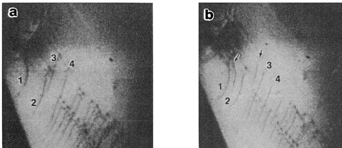
*figure I-4. Effet de l’hydrogène sur la « mobilité » des dislocations dans un acier austénitique AISI 316 d’après Rozenak et al. [5]. a) Sous vide les positions des dislocations sont indiquées par les numéros 1 à 4. b) Sous une pression partielle de 6 kPa d’hydrogène, les flèches indiquent les nouvelles dislocations générées.*
