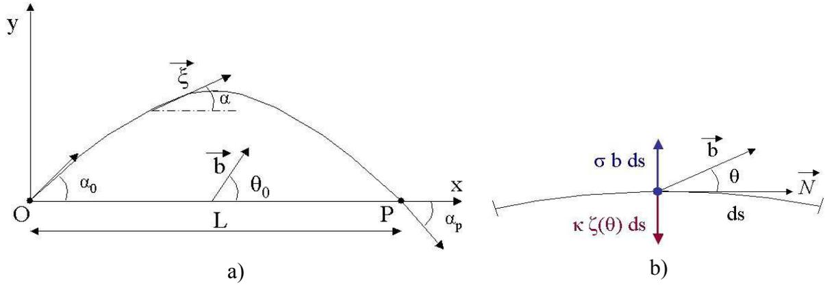
figure III-12. a) Géométrie d'une source de Frank-Read. La dislocation courbée est définie par son vecteur de Burgers  $b$ , son vecteur de ligne  $\zeta$  et le caractère de la dislocation non courbée  $\theta_0$ . b) Equilibre d'un segment de dislocation  $ds$  soumis à la force de Peach-Koehler  $\sigma b ds$ . Cette force est contre-balançée par la tension de ligne  $\zeta(\theta)$  induite par la courbure  $\kappa$  du segment considéré.
