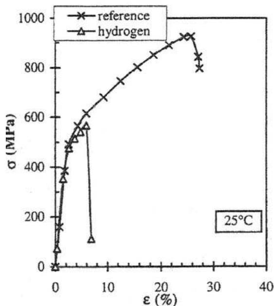
figure IV-21. Courbes contrainte-déformation d'un alliage 600 non chargé et hydrogéné par chargement cathodique (0,74% atomique) pour une vitesse de déformation de  $4 \times 10^{-4} \text{ s}^{-1}$  à la température ambiante. D'après Foct et al. [23].
