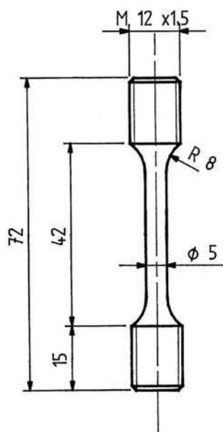
figure II-9. Schéma des éprouvettes cylindriques polycristallines.
