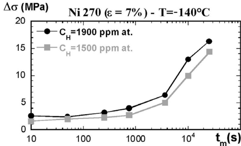
figure II-21. Evolution expérimentale du pic de vieillissement  $\Delta\sigma$  mesuré après une pré-déformation de 7% à  $-140^\circ\text{C}$  en fonction du temps de vieillissement pour du nickel 270 chargé en hydrogène à 1500 ppm atomique et 1900 ppm atomique.
