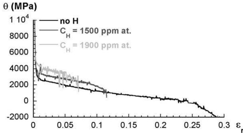
figure IV-17. Courbes taux d'écrouissage-déformation vraie du nickel 270 non chargé et chargé en hydrogène au niveau bas et haut ( $C_H = 1500$  et  $1900$  ppm atomique) à la température ambiante pour une vitesse de déformation de  $10^{-2} s^{-1}$ .
