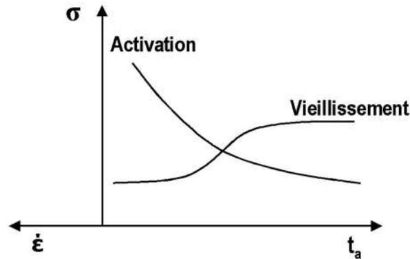
figure II-2. Evolution des deux composantes (activation et vieillissement) de la contrainte de franchissement en fonction du temps de vieillissement  $t_a$  (inversement proportionnel à la vitesse de déformation).
