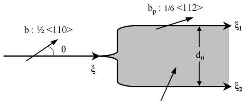
figure III-23. Dissociation d'une dislocation parfaite de vecteur de Burgers  $b$ , de vecteur ligne  $\xi$  et de caractère  $\theta$  en deux partielles ( $b_1$ ,  $\xi_1$  et  $b_2$ ,  $\xi_2$ ) reliées par une bande de faute de largeur  $d_0$ .
