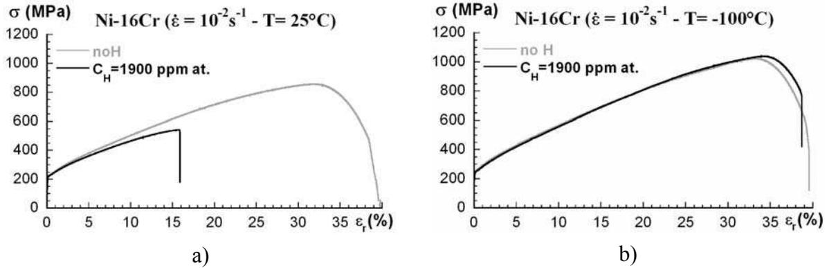
figure II-16. Courbes contrainte vraie-déformation vraie de l'alliage binaire Ni-16Cr non chargé et chargé en hydrogène ( $C_H = 1900$  ppm atomique) pour une vitesse de déformation de  $10^{-2} \text{ s}^{-1}$  pour deux températures : a)  $T = 25^{\circ}\text{C}$  et b)  $T = -100^{\circ}\text{C}$ .
