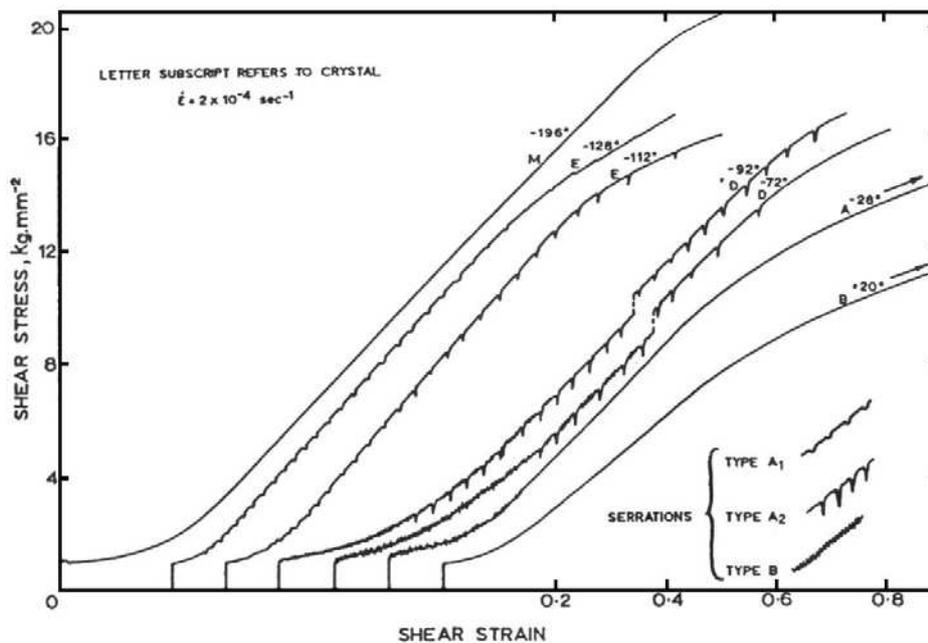
figure I-10. Observation d’instabilités de type Portevin-Le Chatelier dans un monocristal de nickel sur des courbes contraintes déformations pour différentes températures avec  $\dot{\epsilon} = 2 \times 10^{-4} \text{ s}^{-1}$ . D’après Windle et Smith [49].
