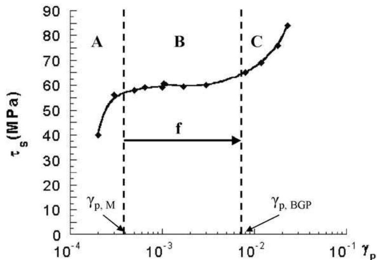
figure IV-3. Courbe d'écrouissage cyclique à saturation en trois stades (A, B, C) de monocristaux de nickel. Dans la gamme B, délimitée par les déformations plastiques  $\gamma_{p,I}$  des phases I (avec  $I = M$  pour Matrice et BGP pour Bandes de Glissement Persistantes), f représente à la fraction volumique occupée par les BGP. D'après Magnin [11]
