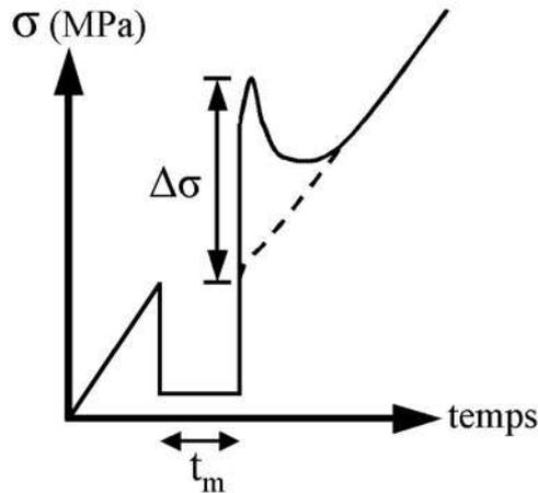
figure II-6. Illustration schématique d'un essai de vieillissement statique sur une courbe contrainte-temps, il apparaît une discontinuité de la limite d'élasticité  $\Delta\sigma$  lors de la remise en charge après un maintien à faible contrainte durant un temps  $t_m$ . En l'absence de vieillissement, le comportement du matériau est représenté par la courbe en pointillée.
