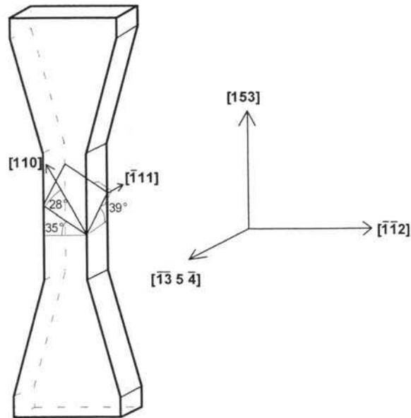
figure IV-2. Représentation schématique de l'orientation cristalline des éprouvettes monocristallines utilisées lors des essais de fatigue ainsi que du système de glissement activé.
