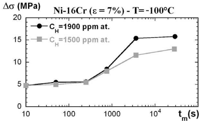
figure II-20. Evolution expérimentale du pic de vieillissement  $\Delta\sigma$  de l'alliage binaire Ni-16Cr, mesuré après une pré-déformation de 7% à  $-100^\circ\text{C}$ , en fonction du temps de vieillissement pour des teneurs en hydrogène de 1500 et 1900 ppm atomique.
