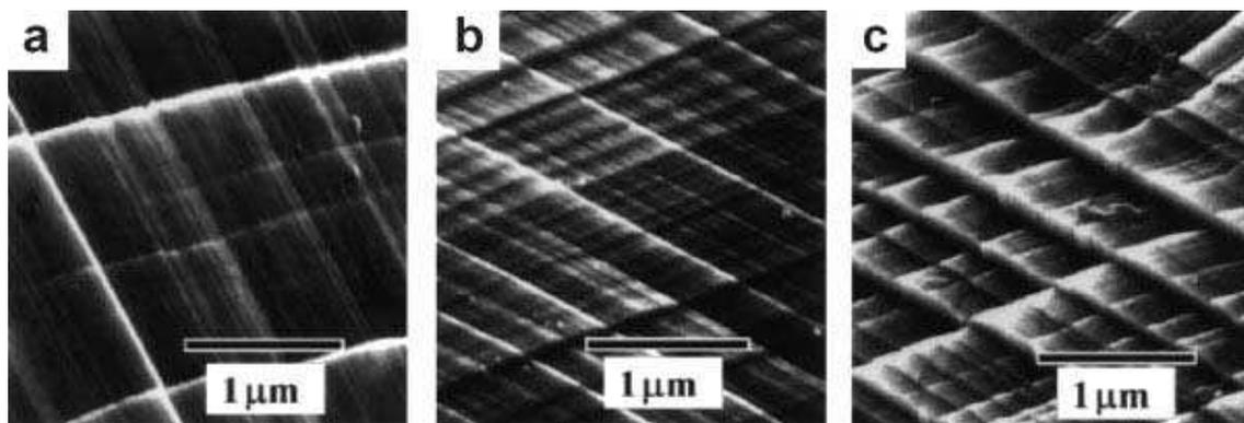
figure I-9. Observation post mortem des surfaces latérales d’éprouvettes d’acier inoxydable AISI 310s ayant subi un essai de traction à la température ambiante et à une vitesse de déformation de  $10^{-5} s^{-1}$ . a) Echantillon non chargé. b) et c) Eprouvettes chargées en hydrogène respectivement à 0,18% atomique et 2,7% atomique. D’après Abraham et Altstetter [42].
