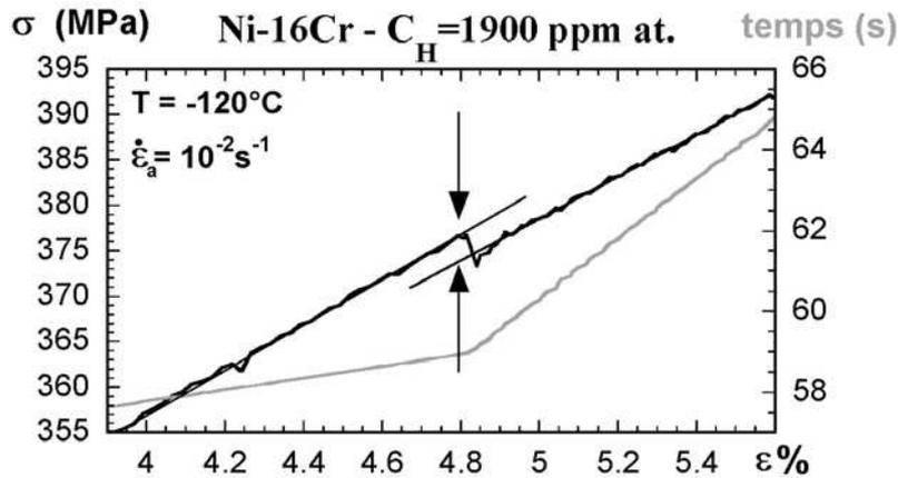
figure II-12. Détermination expérimentale de la sensibilité de la contrainte d'écoulement à la vitesse de déformation. A l'instant du saut de vitesse, la sensibilité à la vitesse est alors évaluée à l'aide de l'équation (II.18). Ici, pour un saut de vitesse entre  $10^{-2} \text{ s}^{-1}$  et  $2 \cdot 10^{-3} \text{ s}^{-1}$  à  $-120^\circ\text{C}$ , la sensibilité à 5% de déformation plastique vaut 1.85 MPa pour un alliage Ni-16Cr contenant 1900 ppm atomique d'hydrogène.
