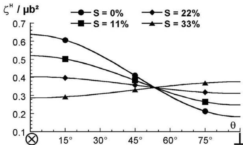
figure III-11. Evolution de la tension de ligne au sens de Jøssang *et al.* normalisée par  $\mu b^2$  en fonction du caractère de la dislocation pour différentes valeurs du taux d'écrantage (avec  $L = R$  et  $R/r_0 = 500$ ).
