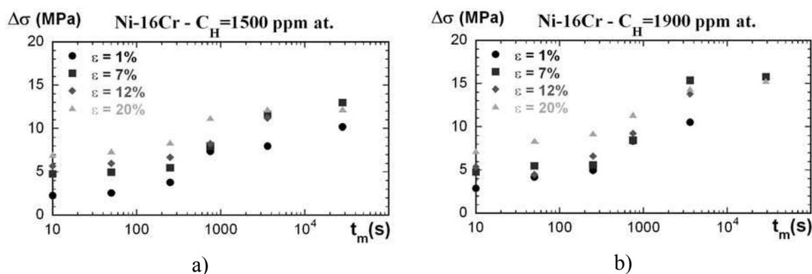
figure II-19. Evolution expérimentale du pic de vieillissement  $\Delta\sigma$ , mesuré à  $-100^\circ\text{C}$  pour l'alliage binaire Ni-16Cr, en fonction du temps de vieillissement mesuré à des pré-déformations de 1%, 7%, 12% et 20% pour a) une teneur en hydrogène de 1500 ppm atomique et b) 1900 ppm atomique.
