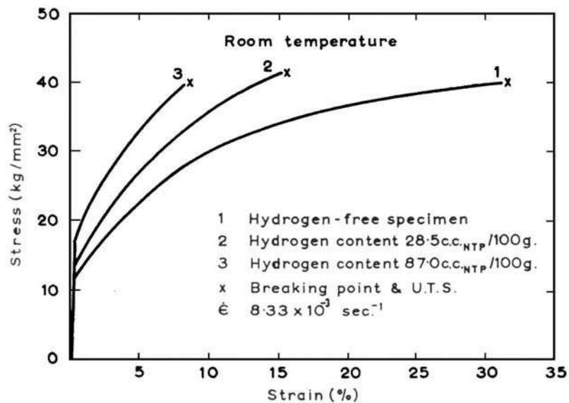
figure I-15. Influence de la teneur en hydrogène sur les courbes contrainte-déformation du nickel « pur » à la température ambiante pour  $\dot{\epsilon} = 8,3 \times 10^{-3} \text{ s}^{-1}$ . D'après Boniszewski et Smith [47].
