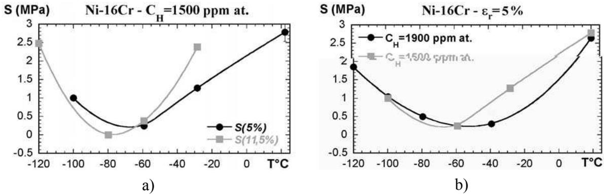
figure II-14. Evolution de la sensibilité  $S(\epsilon)$  de l'alliage Ni-16Cr en fonction de la température pour une vitesse de déformation de  $10^{-2} \text{ s}^{-1}$  en fonction de :
