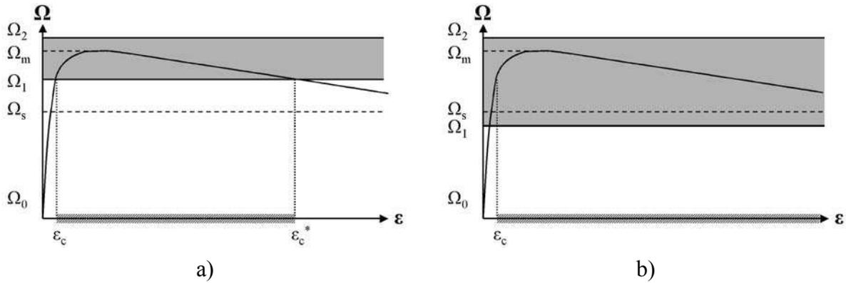
figure II-5. Détermination du domaine d'existence des instabilités par le « dislocation model ». Avec  $\Omega_0$ ,  $\Omega_m$  et  $\Omega_s$  valeurs initiale, maximale et à saturation de  $\Omega(\varepsilon)$ ,  $\Omega_1$  et  $\Omega_2$  déformations élémentaires satisfaisant la condition  $S(\varepsilon) = 0$ ,  $\varepsilon_c$  et  $\varepsilon_c^*$  déformations critiques d'apparition et de disparition du PLC.
