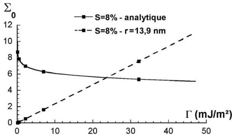
figure III-33. Evolution du paramètre géométrique réduit  $\Sigma_0$  obtenu par minimisation du bilan énergétique du nœud de caractère  $\theta = 19^\circ$  pour  $S(T,c) = 8\%$  en fonction de l'énergie de défaut d'empilement  $\Gamma$ . La variation de  $\Sigma_0$  correspondant à un rayon de courbure interne de 13,9 nm et à une largeur de dissociation tenant compte d'un effet d'écrantage de 8% est représentée par la courbe pointillée.
