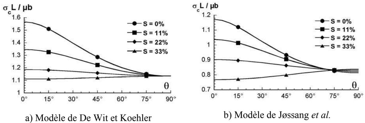
figure III-14. Evolution de la contrainte critique d'activation en fonction du caractère de la dislocation avec  $R/r_0 = 1250$  pour différentes valeurs du taux d'écrantage pour deux expressions de la tension de ligne a) Modèle de De Wit et Koehler, b) Modèle de Jøssang *et al.*.
