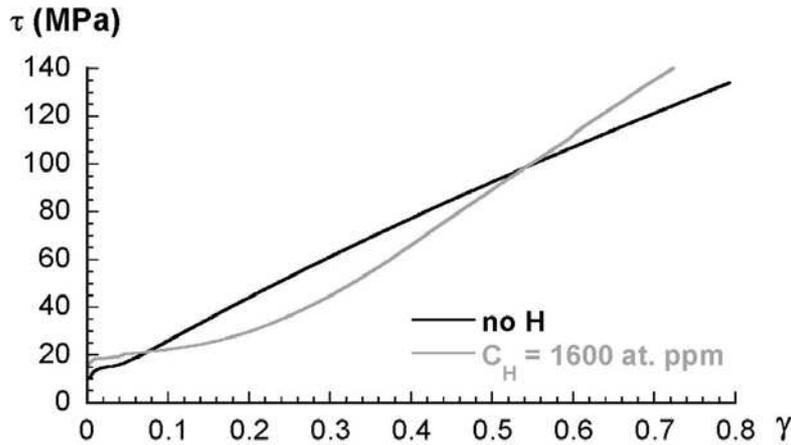
figure IV-10. Courbes contrainte résolue-cisaillement à la température ambiante de monocristaux de nickel orientés pour glissement simple. Le comportement du matériau non chargé est représenté en noir et celui du monocristal contenant 1600 ppm atomique d'hydrogène en gris.
