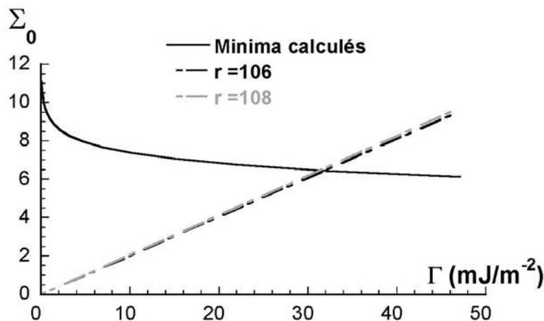
figure III-32. Variation des paramètres géométriques réduits  $\Sigma_0$  calculé et expérimental en fonction de l'énergie de faute d'un nœud de caractère  $\theta = 8^\circ$ .
