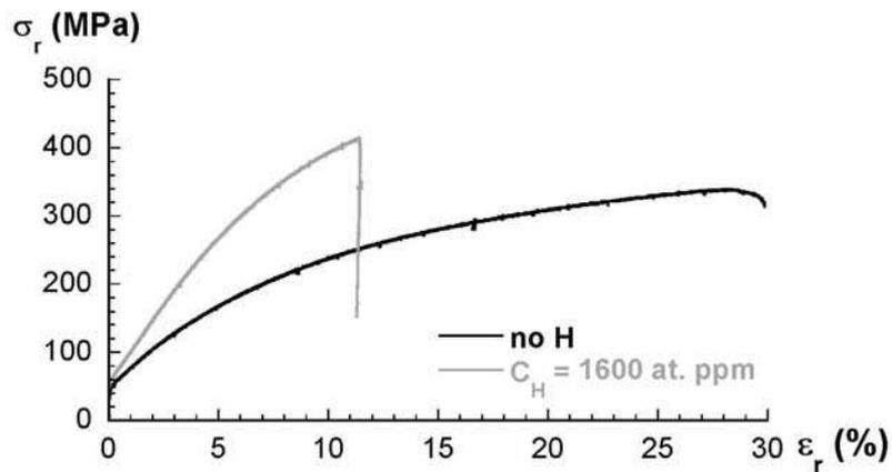
figure IV-18. Courbes contrainte vraie-déformation vraie de monocristaux de nickel orientés pour glissement multiple non hydrogéné et chargé en hydrogène ( $C_H = 1600$  ppm atomique) à la température ambiante pour une vitesse de déformation de  $10^{-2} s^{-1}$ .
