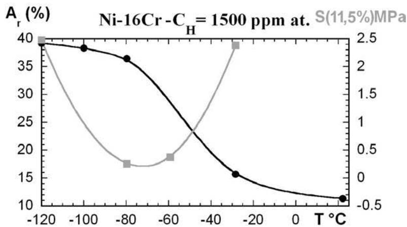
figure II-17. Variation de l'allongement à rupture et de la sensibilité  $S(\epsilon)$  mesurée à 11,5% de l'alliage Ni-16Cr contenant 1500 ppm atomique d'hydrogène en fonction de la température pour une vitesse de déformation de  $10^{-2} \text{ s}^{-1}$ .
