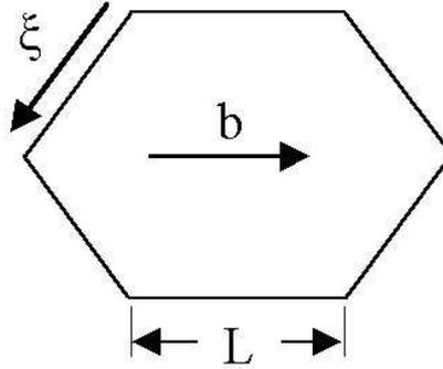
figure III-15. Modélisation d'une boucle de dislocation isotrope en segments rectilignes.
