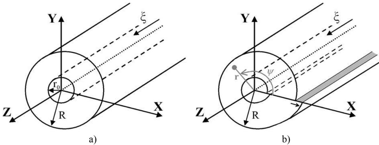
figure III-1. Schéma de création d'une dislocation coin. a) Etat initial sans dislocation, cylindre de cristal infiniment long de rayon  $R$ . b) Introduction d'une dislocation coin de rayon de cœur  $r_0$  et de vecteur de ligne  $\xi$  au centre de ce cylindre par le processus de « coupure-déplacement » de Volterra.
