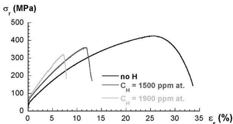
figure IV-15. Courbes contrainte vraie-déformation vraie du nickel 270 polycristallin non chargé et chargé en hydrogène aux niveaux « bas » et « haut » ( $C_H = 1500$  et  $1900$  ppm atomique) pour une vitesse de déformation de  $10^{-2} \text{ s}^{-1}$  à la température ambiante.
