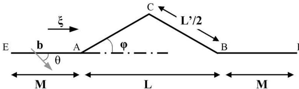
figure III-10. Modélisation de la courbure d'une dislocation d'après Jøssang *et al.* [8, 9] avec  $b$  vecteur du Burgers de la dislocation considérée,  $\xi$  le vecteur unitaire parallèle à la ligne de dislocation,  $L$  la longueur du segment courbé et  $M$  la longueur des branches non courbées (dans la suite,  $M$  sera considérée comme infinie).
