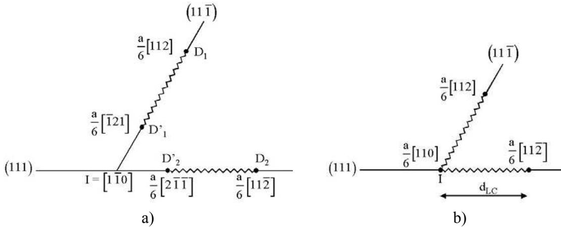
figure III-27. Formation d'une barrière de Lomer-Cottrell. a) Etat initial faisant suite à la dissociation des dislocations  $\Delta_1$  et  $\Delta_2$ . b) Formation de la barrière de Lomer-Cottrell d'après Friedel [3].
