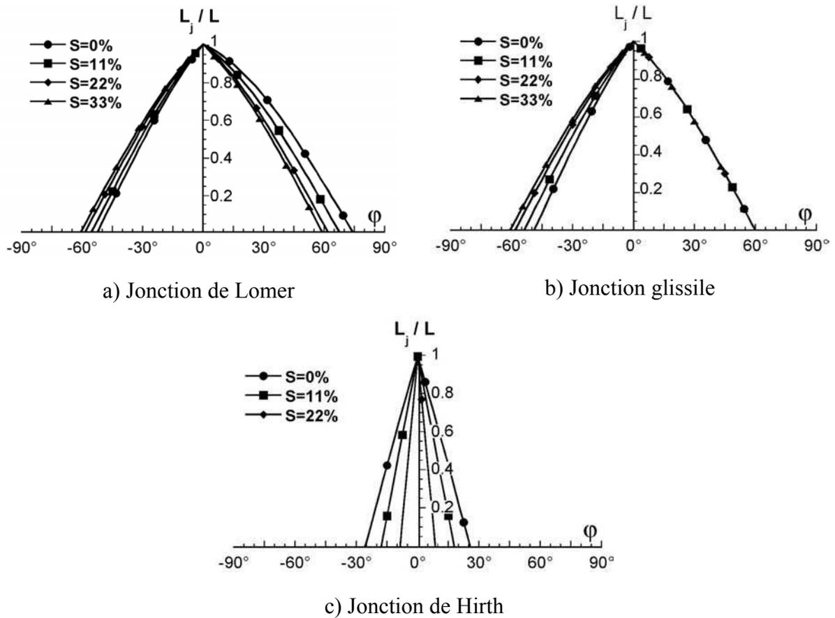
figure III-21. Variation de la longueur de jonction  $L_j$ , normalisée par la longueur initiale des dislocations  $L$ , en fonction de l'angle initial des dislocations par rapport à l'axe de jonction dans le cas symétrique ( $\phi_1 = \phi_2 = \phi$ ) pour différentes valeurs d'écrantage dans le cas a) d'une jonction de Lomer, b) d'une jonction glissile et c) d'une jonction de Hirth.
