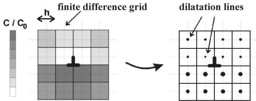
figure III-3. Représentation schématique de la discrétisation de la distribution en hydrogène autour d'une dislocation. Le profil continu de concentration est transformé en une distribution discrète de lignes de dilatations situées au centre de chaque boîte élémentaire de section carrée. Leur amplitude est proportionnelle à la concentration en hydrogène de chaque boîte. D'après Chateau et al. [2].
