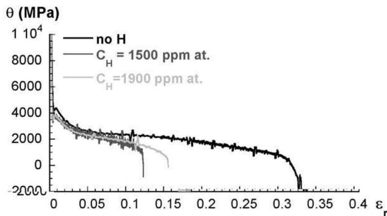
figure IV-20. Courbes taux d'écrouissage-déformation vraie de l'alliage binaire Ni-16Cr non chargé et chargé en hydrogène aux niveaux « bas » et « haut » ( $C_H = 1500$  et  $1900$  ppm atomique) pour une vitesse de déformation de  $10^{-2} \text{ s}^{-1}$  à la température ambiante.
