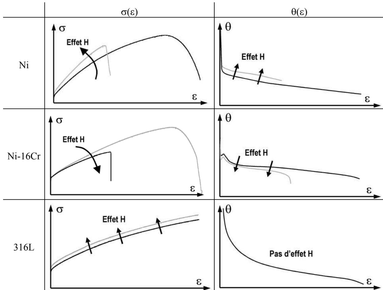
figure IV-24. Représentation schématique des effets induits par l'hydrogène sur le nickel, l'alliage binaire Ni-16Cr et un acier inoxydable austénitique 316L.
