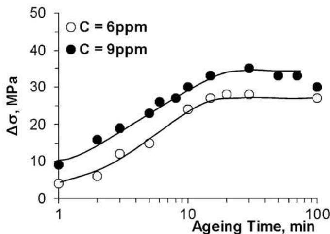
figure II-22. Evolution du pic de vieillissement  $\Delta\sigma$  mesuré après une pré-déformation de 5% à  $100^\circ\text{C}$  en fonction du temps de vieillissement dans le cas d'un acier à durcissement structural pour des teneurs en carbone de 6 et 9 ppm massique. D'après De *et al.* [25].
