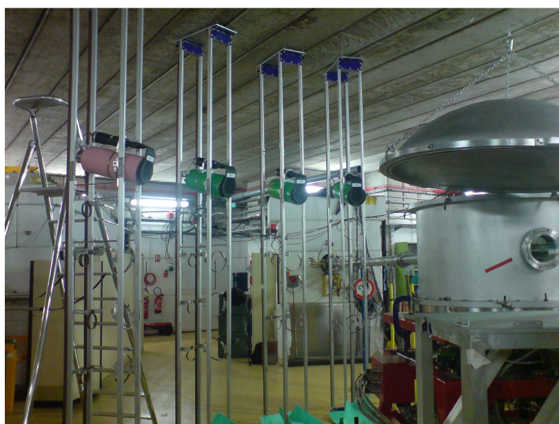
Figure 17 : photographie des DéMoN et des SyReP installés sur leur support à l'arrière de la chambre à réaction.
