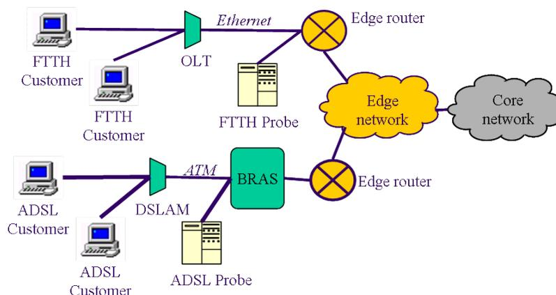
FIGURE 4.1 – Placement des sondes dans le réseau de collecte
