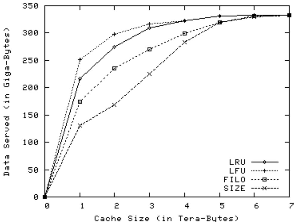
FIGURE 4.10 – Performance d'un cache passif en fonction de la capacité de stockage
