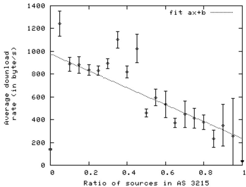
FIGURE 5.5 – Moyenne des débits de téléchargement en fonction du ratio de sources internes
