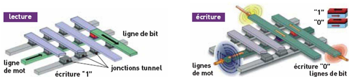
Figure A-1-6 : Principe de fonctionnement de cellules MRAM conventionnelle.
