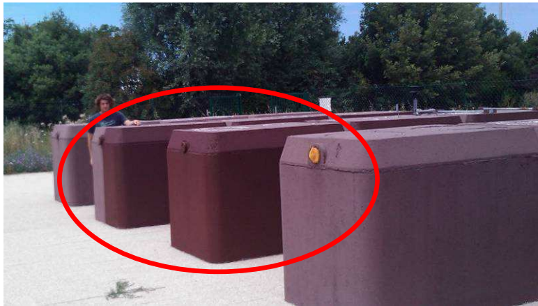
Figure 75: Banc d'essai avec les 3 configurations de peintures aux surfaces des rues canyons
