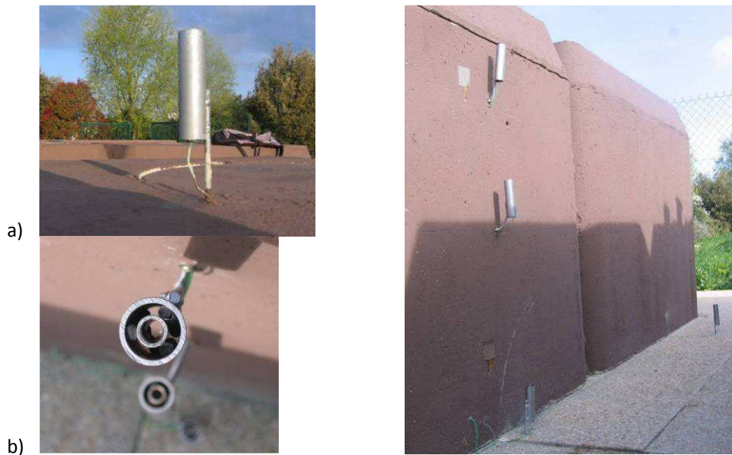
Figure 72: tube basse émissivité de protection pour thermocouples air
