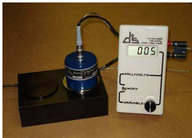
Figure 35: Émissionmètre Modèle AE avec son voltmètre Digital
