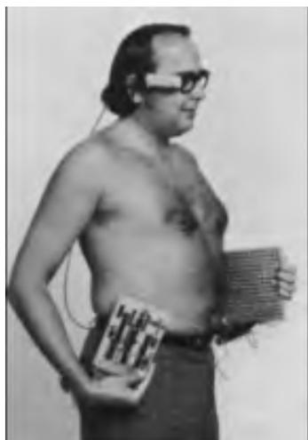
Figure 1.5 : la version portable du TVSS. La caméra est placée au niveau des lunettes, le stimulateur tactile se place au niveau du ventre. D'après Bach-y-Rita, 1972.
