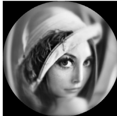
Figure 3.22 : illustration de l'effet de l'échantillonnage spatialement variant appliqué à une image. Grâce à la forte densité des échantillons, la résolution dans la zone centrale est élevée
