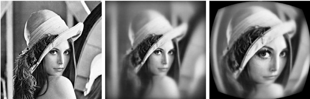
Figure 2.29 : application de la projection retino-corticale. A gauche : image d'origine. Au centre : filtrage passe-bas spatialement variant de l'image d'origine. A droite : image projetée, avec un taux de magnification centrale  $R0 = 4$  et un taux de réduction de l'image  $k = 1$  (pas de réduction).
