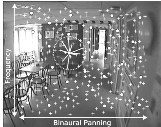
Figure 3.4 : conversion image/son dans le logiciel TheVIBE. Un champ récepteur (cercle pointillé blanc) est un ensemble de pixels en général voisins. A chaque champ récepteur est attribué une source sonore dont les paramètres (fréquence et panoramique) dépendent de la position du champ récepteur dans l'image (matérialisée par un point blanc). Le volume sonore attribué à chaque source est fonction de la moyenne des niveaux de gris des pixels constituant le champ récepteur. Le son associé à l'image est la somme des sources sonores.
