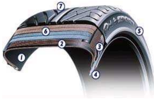
FIG. 3.33 – Coupe transversale d'un pneumatique.
