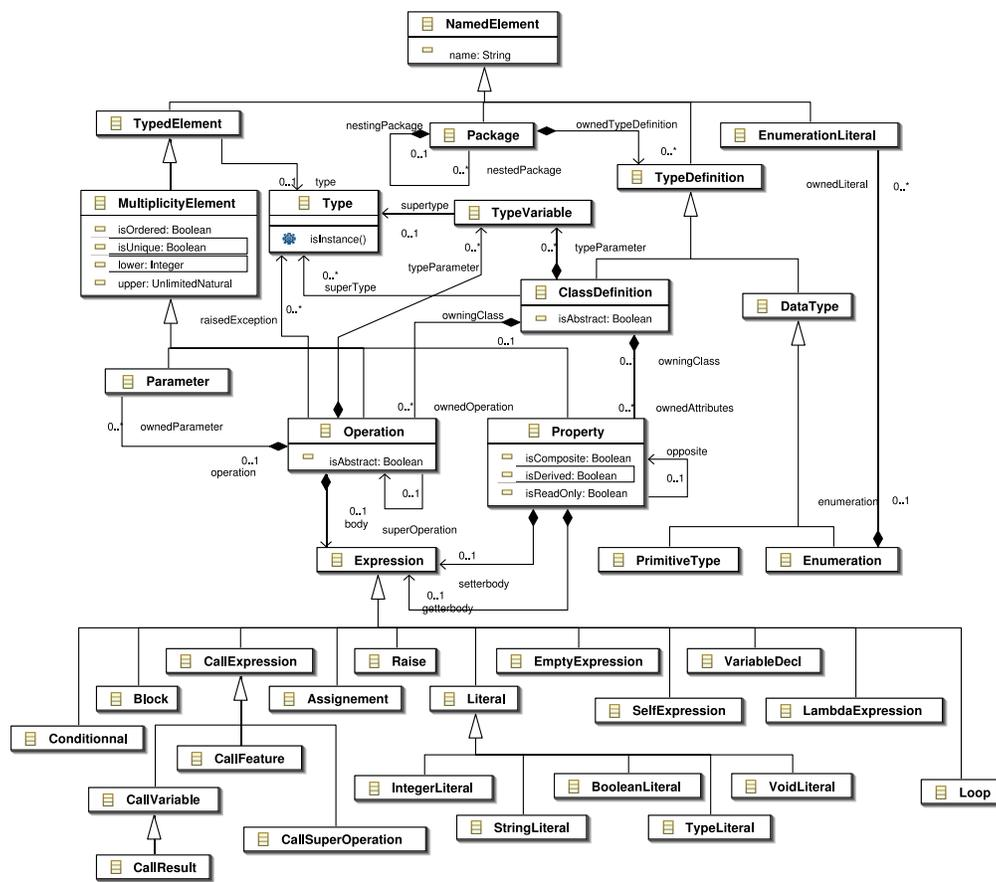
Figure 11 : principales classes du metamodelle de Kermeta
