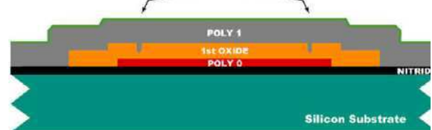
Figure B.5 : Dépôt de la première couche structurale poly1.
