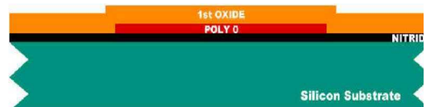
Figure B.3 : Dépôt de la première couche sacrificielle.
