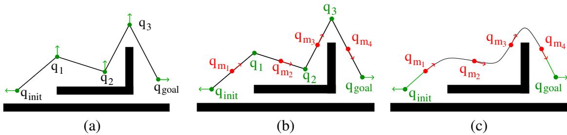
FIG. 4.9 – (a) Chemin obtenu après l'étape de planification de mouvement de l'algorithme *ILP* interactif. (b) A partir de ce chemin sont ajoutées les configurations situées au centre de chaque chemin local et on les oriente le long du chemin. Les orientations de  $q_{init}$  et  $q_{goal}$  sont conservées. (c) Les configurations  $q_i$  sont éliminées et des chemins locaux de Bézier sont créés entre les  $q_{m_i}$ . En vert apparaissent les parties holonomes de la trajectoire.
