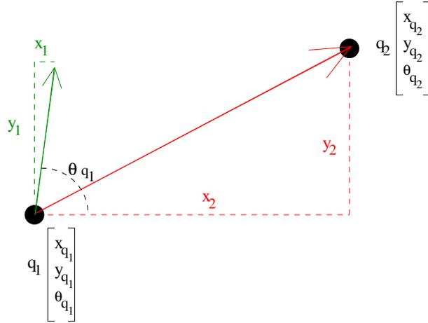
FIG. 4.7 – En rouge le vecteur  $q_1 - q_2$  représenté par  $x_2$  et  $y_2$ . En vert le vecteur unitaire correspondant à l'orientation de  $q_1$ , représenté par  $x_1$  et  $y_1$ . En noir, les configurations  $q_1$  et  $q_2$  représentées par leurs coordonnées  $(x_{q_i}, y_{q_i}, \theta_{q_i})$
