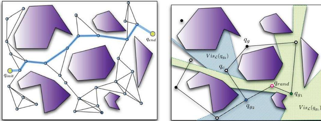
FIG. 2.8 – De [Esteves Jaramillo 2007]. Comparaison des méthodes *PRM* (à gauche) et *VISPRM* (à droite). Pour l’algorithme *VISPRM*, on peut apercevoir en vert et en bleu les zones de visibilité des nœuds  $q_{g1}$  et  $q_{g2}$ .
