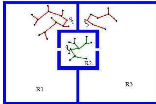
FIG. 2.7 – Un exemple d’arbres locaux. La méthode a de fortes probabilités de générer des nœuds dans les trois régions  $R_i$ . Le résultat sera une diffusion de trois arbres dans ces trois régions. La probabilité de connecter deux arbres sera plus grande s’il y a un arbre de plus dans la région  $R_2$  que s’il n’y a que les deux arbres initiaux dans les régions  $R_1$  and  $R_3$ .
