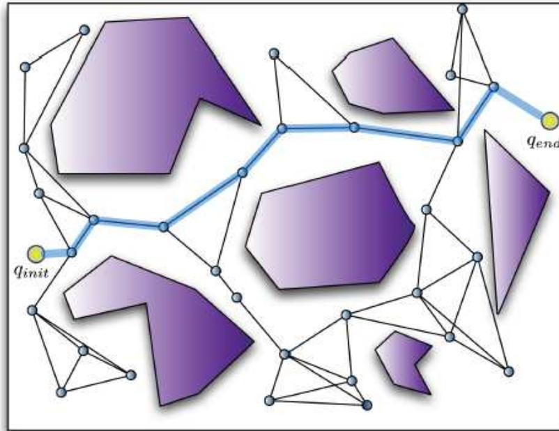
FIG. 2.5 – De [Esteves Jaramillo 2007]. Illustration d'un problème résolu par l'algorithme *PRM*. Le graphe est d'abord construit, puis un chemin est trouvé dans ce graphe pour relier les configurations  $q_{init}$  et  $q_{end}$
