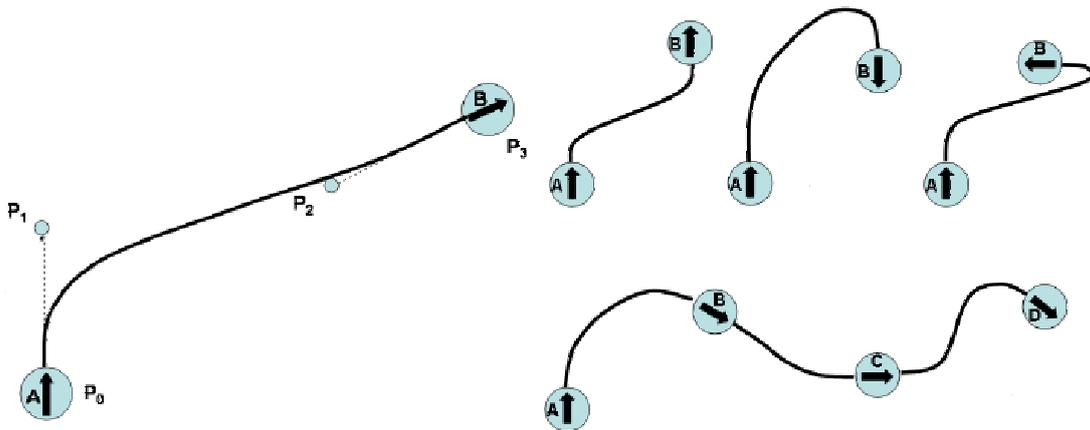
FIG. 4.2 – De [Pettré 2003]. Quelques exemples de chemins locaux construits avec des courbes de Bézier. En bas à droite, un exemple de chemin global composé de plusieurs chemins locaux de Bézier.
