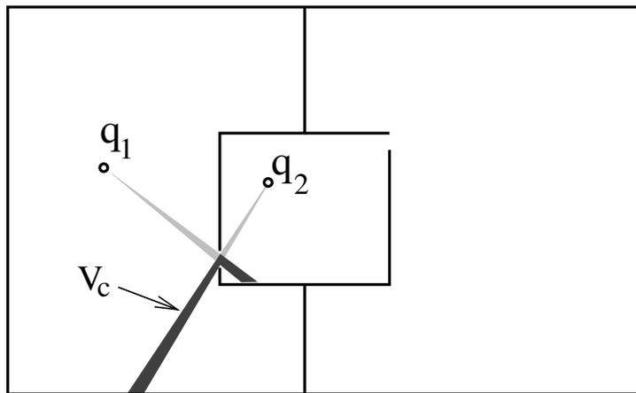
FIG. 2.9 – Un exemple de la difficulté de créer un nœud de connexion avec la méthode Visibility PRM. Un nœud de connexion ne peut être créé que si un échantillon est tiré dans la région  $V_C$ , région de visibilité commune de  $q_1$  et  $q_2$ . La probabilité d'avoir une configuration échantillonnée dans la région  $V_C$  (en gris foncé) est faible.
