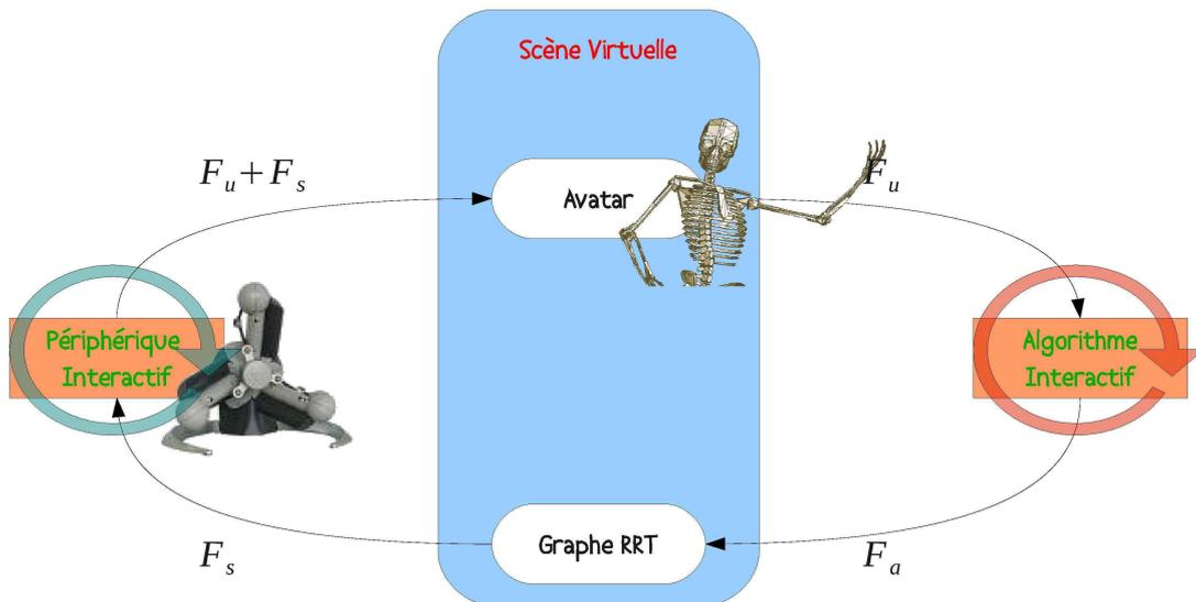
FIG. 3.2 – Boucle générale d'interaction entre l'algorithme et l'utilisateur via la scène virtuelle
