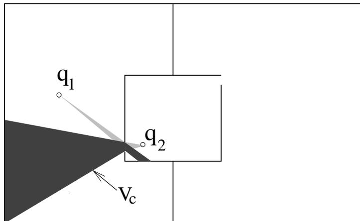
FIG. 2.10 – Comparer le domaine d'échantillonnage  $V_C$  sur cette figure à celui sur la figure 2.9. Le domaine de visibilité commun à  $q_1$  et  $q_2$  est plus grand car  $q_2$  est plus proche du passage étroit. La probabilité d'avoir un échantillon dans  $V_C$  est donc plus grande.
