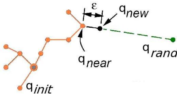
FIG. 2.6 – Illustration du principe d'extension du *RRT*
