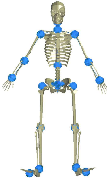
FIG. 4.1 – Eugène, le squelette virtuel utilisé dans les tests de ce chapitre. En bleu, les différentes articulations d’Eugène sont affichées, représentant 63 degrés de liberté au total.
