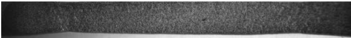
FIGURE 4.10 : Observation de la multistriction sur l'éprouvette plate sollicitée en traction rapide.
