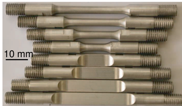
FIGURE 4.1 : Géométries testées pour les essais de dynamique rapide aux barres de Hopkinson.
