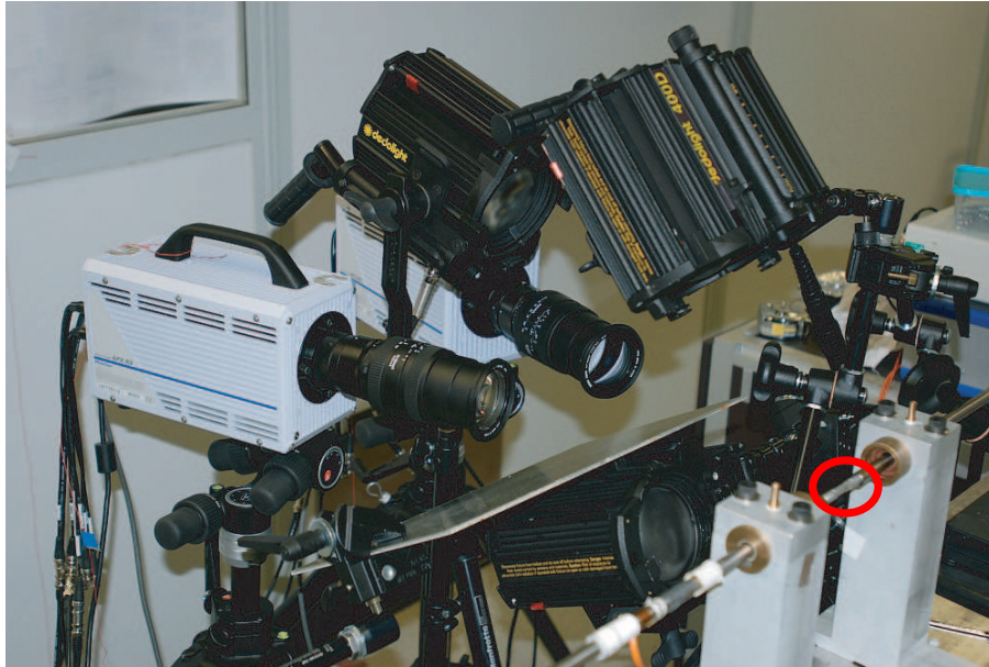
FIGURE 4.4 : Dispositif d'acquisition pour les essais de traction sur barres de Hopkinson. Trois projecteurs assurent l'éclairage. Nous distinguons les deux caméras, celle de gauche étant en retrait. Une plaque est disposée au-dessus du projecteur du bas afin d'éviter l'échauffement des objectifs. L'emplacement de l'éprouvette sur les barres est symbolisé par un cercle rouge.
