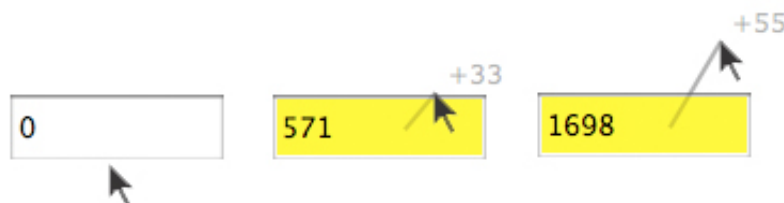
FIG. 5.14 : Une entrée numérique augmentée d'une "interaction joystick"
