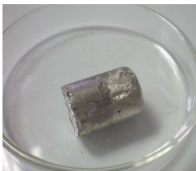
Figure A-2. Photographie d'un bloc de Bi obtenu après purification
