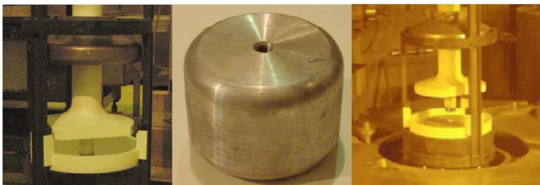
Figure II-6. Prototype de cathode liquide de cadmium développé à l'ANL
