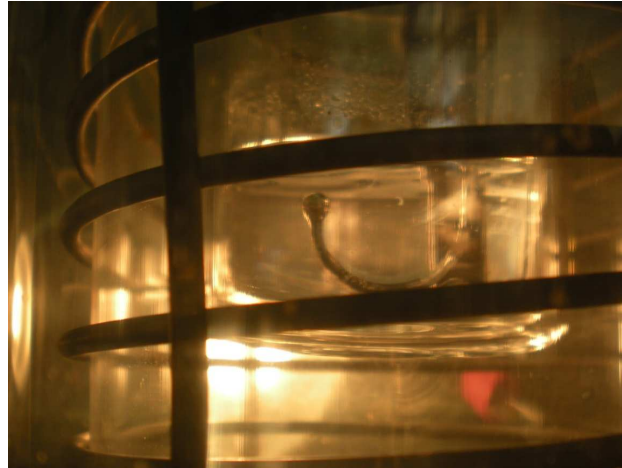
Figure V-15. Cliché de la canule de récupération des gouttes de Bi liquide immergée en milieu LiCl-KCl à 450 °C
