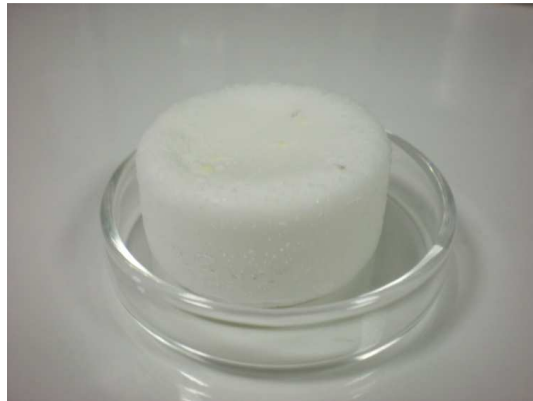
Figure A-1. Photographie d'un bloc de LiF-CaF 2 obtenu après purification
