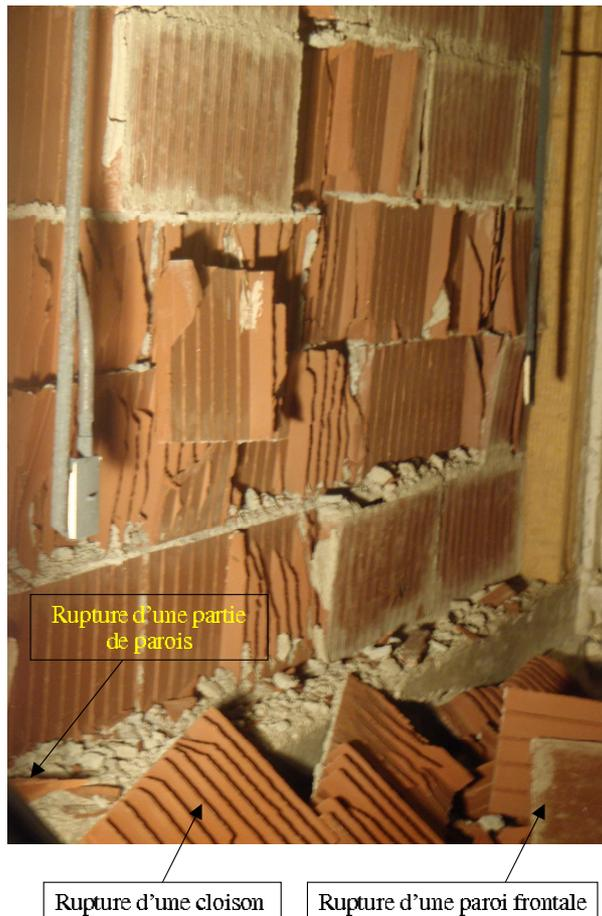
FIG. 4.5 – *Formes des pièces écaillées côté exposé*
