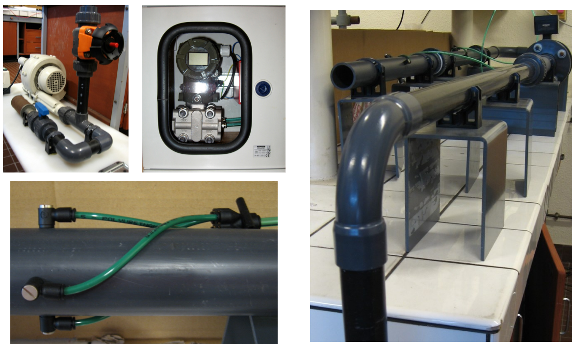
FIGURE 4.83 – Photographies de l'équipement utilisé dans l'unité pilote de mesure de perte de charge dans les textiles : gestion du flux, capteur de pression différentielle, points de mesure et vue d'ensemble.
