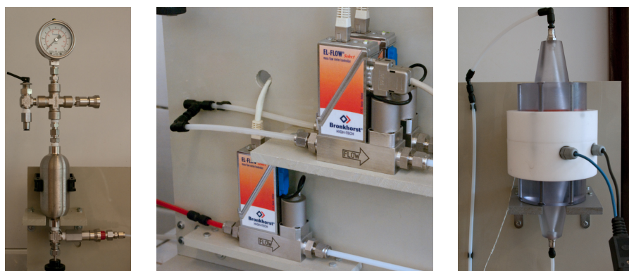
FIGURE 4.84 – Photographies de l'équipement utilisé dans l'unité pilote d'adsorption en dynamique : réservoir de COV sous forme liquide, jeu de contrôleur massique gaz et module d'adsorption-désorption pour les textiles
