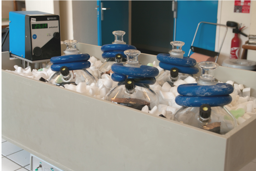
FIGURE 2.28 – Exemple d'utilisation du bain thermostaté pour la mesure d'adsorption en statique.
