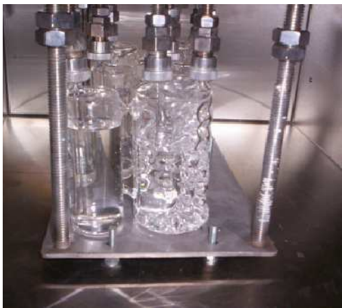
Photographie 2 : Flacons de saturation (étuve 1)
