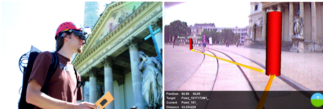
FIG. 1.18: La plate forme Studierstube [Reitmayr et Schmalstieg, 2003] (a) La plate-forme matérielle (b) Exemple d'augmentation
