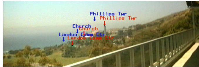
FIG. 3.3: Exemple d'annotations dans un environnement extérieur [You et al., 1999] : avec les données inertielles sans correction (en bleu) et avec correction en utilisant la vision (en rouge)
