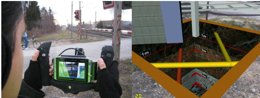
FIG. 1.23: (a) Prototype de Vidente (b) Visualisation des tuyaux de canalisation [Schall et al., 2007]
