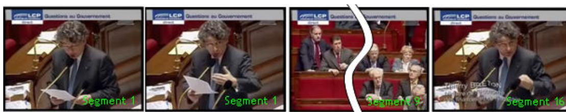
**Figure 83 : Validation d'un service « dynamique » : le numéro de séquence s'incrémente en fonction des détections de changement de scène**
