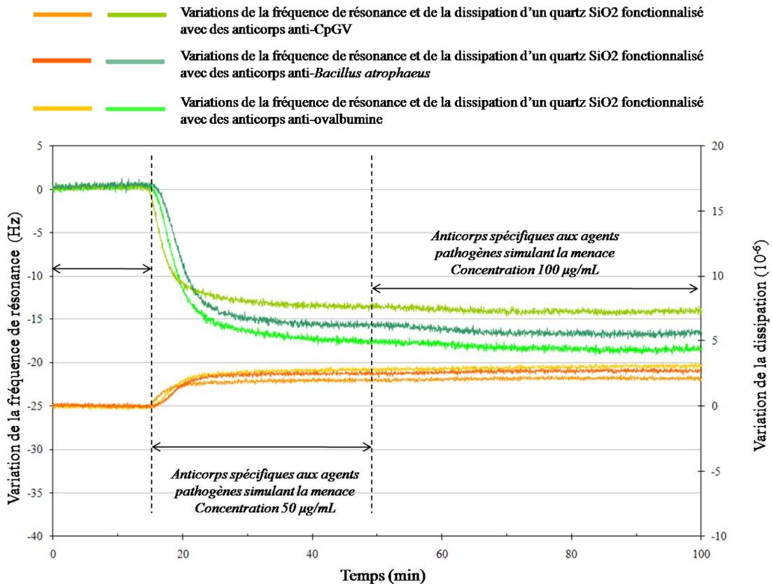
Figure 4.5 : Graphique des variations de la fréquence de résonance et de la dissipation pour la 7<sup>ème</sup> harmonique de 3 quartz SiO<sub>2</sub> en parallèle, pour l'injection d'une gamme de solution d'anticorps anti-ovalbumine, anti-*Bacillus atrophaeus* et anti-granules CpGV et de concentrations 50 et 100 µg/ml.
