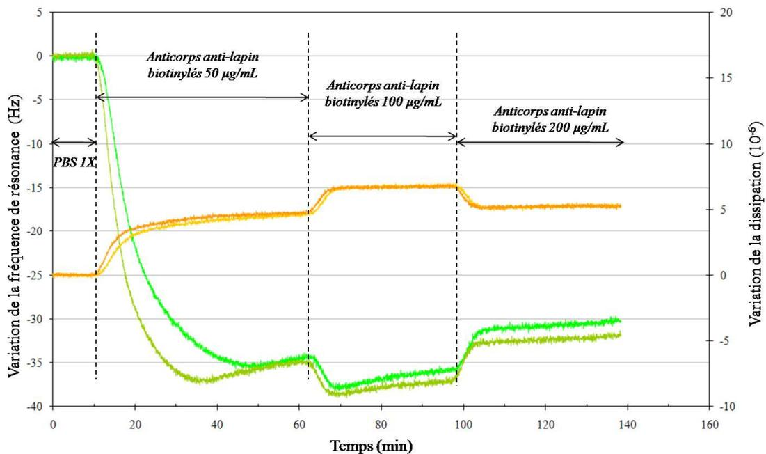
Figure 4.3: Graphique des variations des fréquences de résonance et des dissipations pour la 7ème harmonique de 2 quartzs SiO<sub>2</sub> en parallèle, pour l'injection d'une gamme de solution d'anticorps anti-lapin biotinylés de concentrations 50, 100 et 200  $\mu\text{g/ml}$ .
