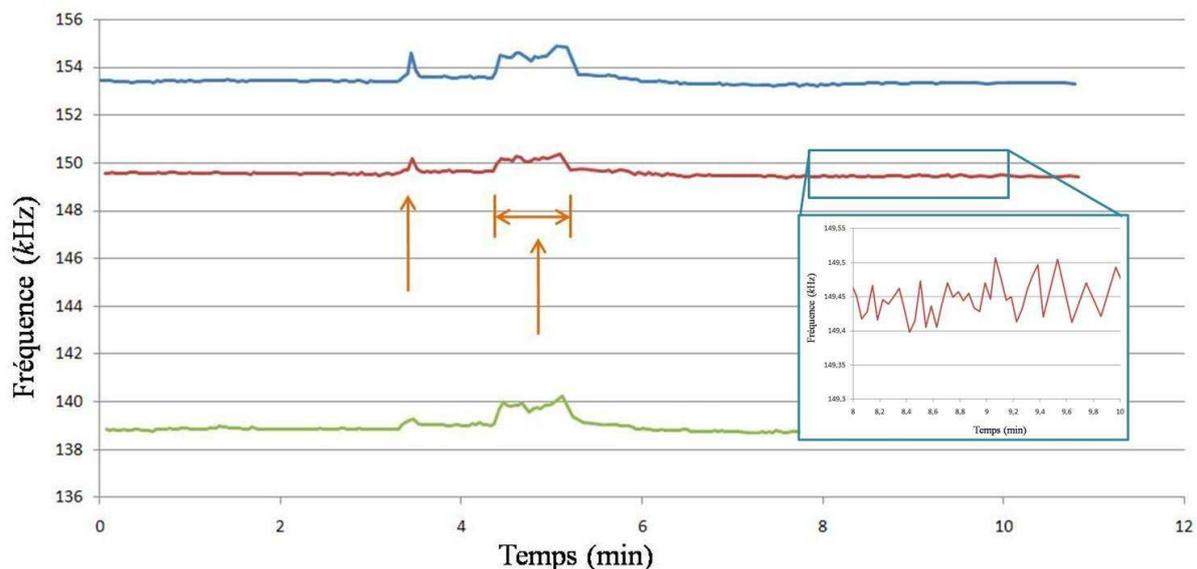
Figure 3.15 : Stabilité dans le temps du suivi de la fréquence de résonance de trois micromembranes résonant selon le mode (0,1) (micromembrane respectivement de rayon 420  $\mu\text{m}$ , courbe bleue ; de rayon 430  $\mu\text{m}$ , courbe rouge ; de rayon 440  $\mu\text{m}$ , courbe verte).
