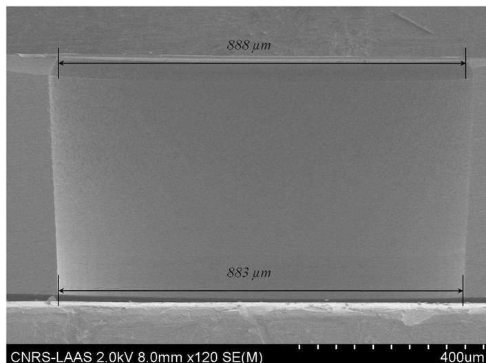
Figure 2.21 : micrographe obtenu par microscopie électronique à balayage de la coupe d'une membrane après gravure face arrière par DRIE du silicium du substrat. Est représentée ici, une des meilleures configurations obtenues (2,5 μm de sur-gravure latérale seulement)
