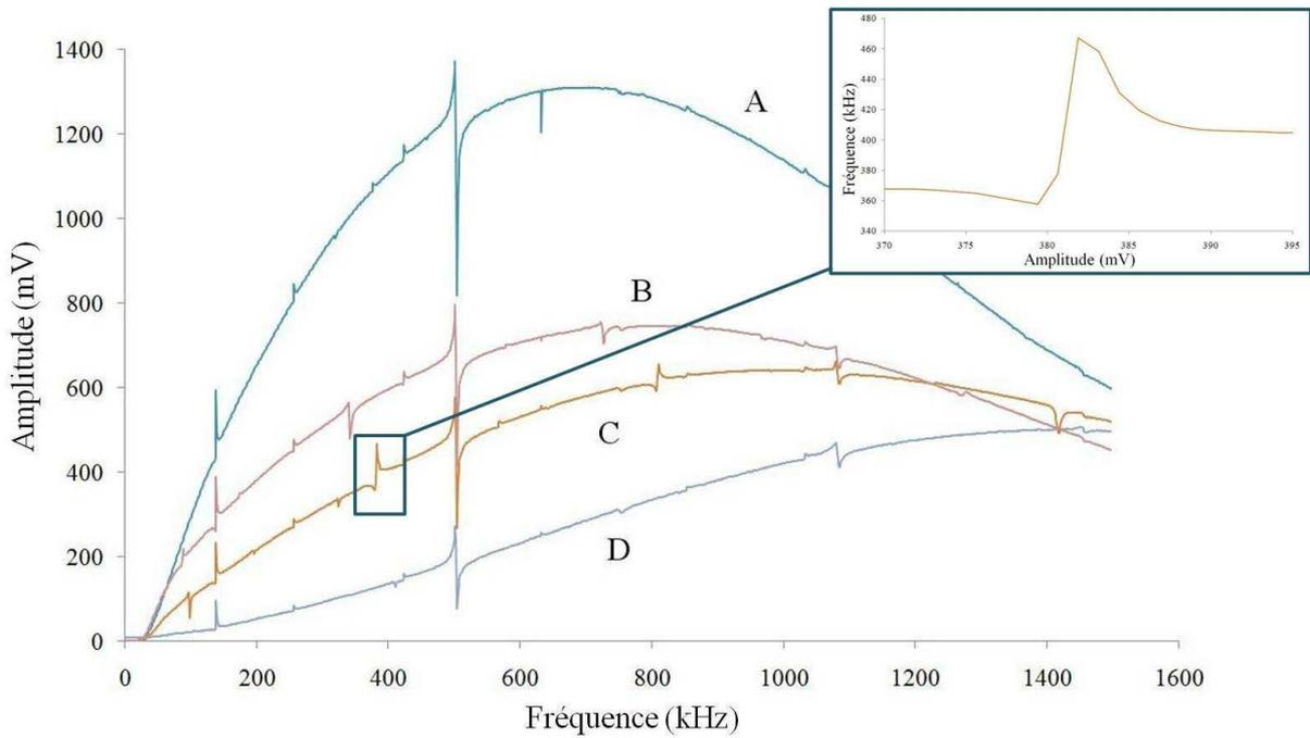
Figure 3.3 : Spectres en fréquence obtenus en réalisant un balayage en fréquence de 40 kHz à 1500 kHz pour les 4 membranes de mesure d'une puce. La courbe A est liée à la membrane de rayon 420  $\mu\text{m}$ , la courbe B est liée à la membrane de rayon 440  $\mu\text{m}$ , la courbe C est lié à la membrane de rayon 430  $\mu\text{m}$ , enfin la courbe D est lié à la membrane de rayon 400  $\mu\text{m}$ ,
