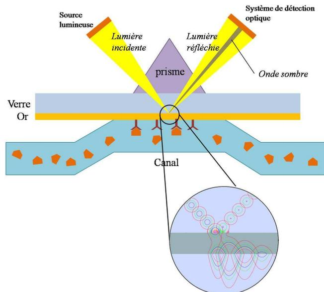
Figure 1.8 : Principe de la résonance plasmonique de surface
