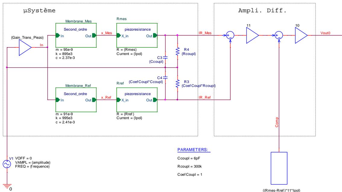
Figure C.1 : Circuit électrique équivalent modélisant l'influence des capacités et des résistances parasites de la pastille piézoélectrique sur la mesure de la résonance mécanique par les piézorésistances de la membrane de mesure et de la membrane de référence.
