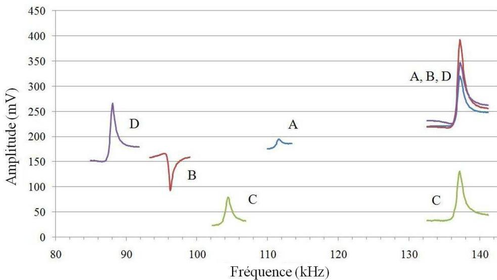
Figure 3.4 : Détail des spectres de résonances pour le mode de vibration fondamental de quatre membranes avec un rayon de 440  $\mu\text{m}$  (courbe violette, D), avec un rayon de 430  $\mu\text{m}$  (courbe rouge, B), avec un rayon de 420  $\mu\text{m}$  (courbe verte, C) et avec
