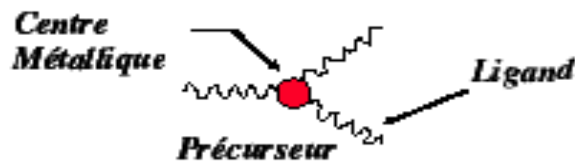
Illustration 14 : Représentation schématique d'un précurseur organométallique
