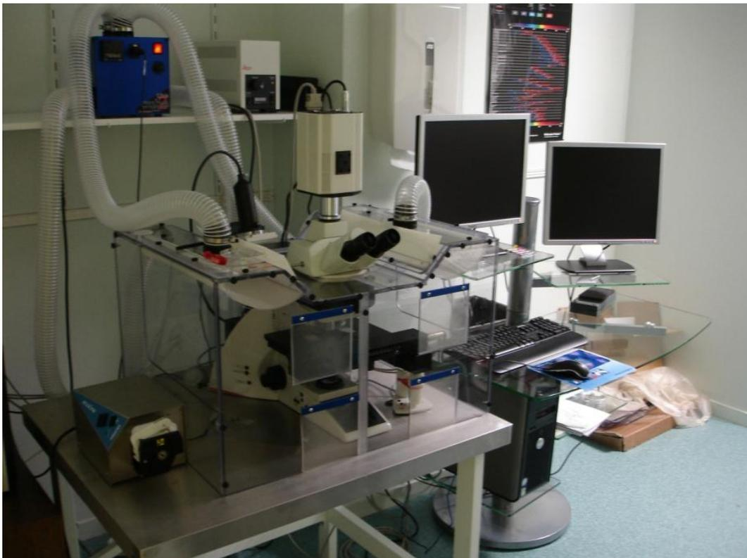
**Figure 25 : Station de vidéomicroscopie comprenant l'enceinte thermostatée, le microscope, la pompe péristaltique. La station est pilotée avec le logiciel MetaMorph.**
