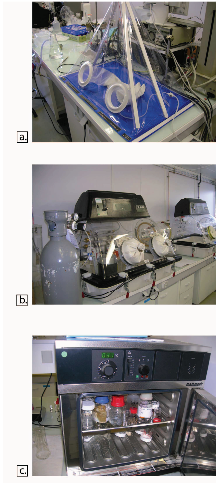
Figure II- 1: Présentation de l'outil expérimental utilisé dans le cadre des expériences d'altération en atmosphère contrôlée. (a) Boîte à gant portable dans laquelle les mesures de Eh et pH étaient effectuées tous les mois. (b) Boîte à gant fixe dans laquelle était placé le matériel mis à dégazer (mélange d'argon 90% et d'hydrogène 10%) avant les mesures et prélèvements. (c) Etuve réglée à 40°C et réacteurs en verre remplis du mélange poudre de roches-solution d'eau déionisée- CO 2 10%. Pour ce dispositif expérimental, la durée totale d'expérience est d'un an.
