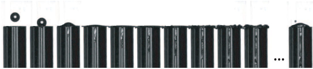
Fig. 1.39- Vitesse d'impact de 2,3 m/s pour un tube de 0,3 mm de rayon. Entre deux images il y a 0,53 ms et la dernière image est prise à la fin à 2,5 ms.
