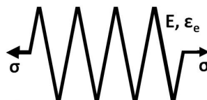
FIGURE II.18 – Symbole d'un matériau ayant un comportement élastique pur
