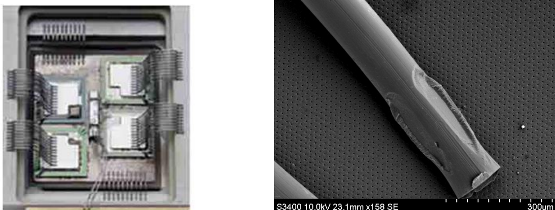
FIGURE I.8 – Observation de fils de bonding, vue d'ensemble (a), Observation au MEB (b)
