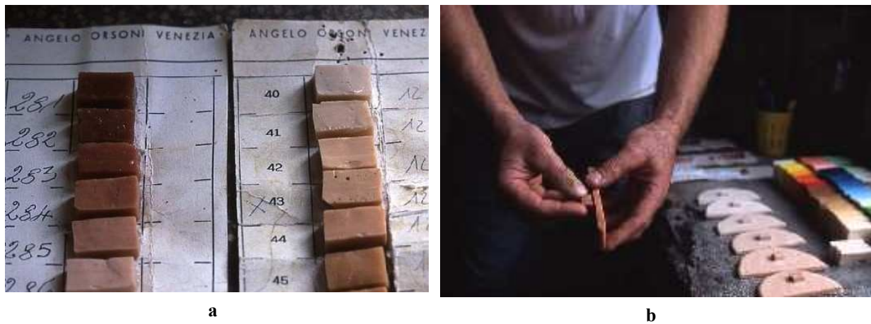
Figure 15 (a) Tesselles de mosaïque de différentes teintes obtenues par opacification à l'aide d'un « corpo ». Plus la quantité de « corpo » ajoutée est grande, plus la teinte obtenue est claire ; (b) contrôle visuel de la teinte de verre opaque obtenue par le verrier. (© Orsoni).
