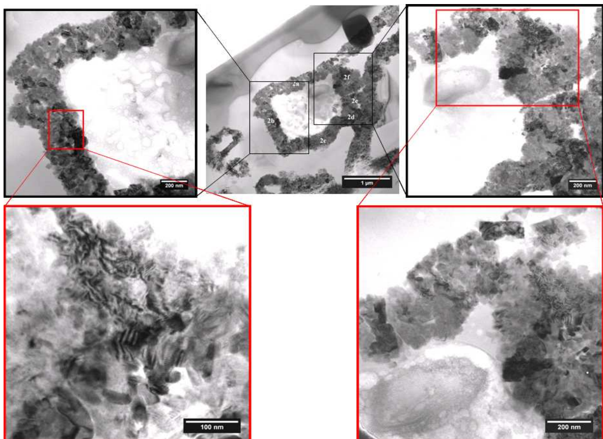
Figure 111 Images MET à différentes échelles de la lame FIB effectuée dans un agrégat de cristaux de verre blanc égyptien.
